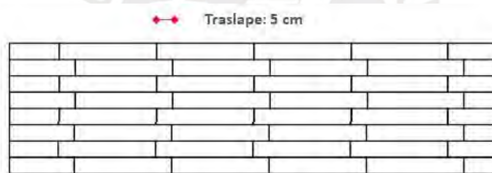
Figura 3.8 Vista frontal del criterio usado para el arreglo 2
