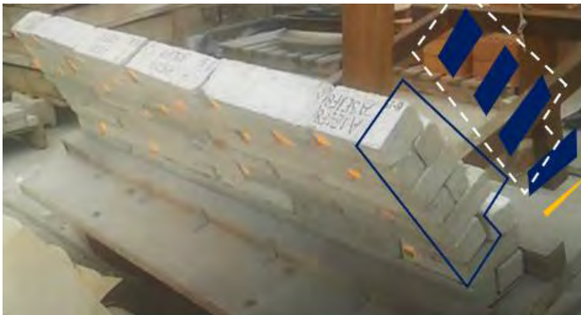
Figura 5.19 Forma de falla para A3V1 (los bloques azules son las 'piedras' pasantes y la cuña anaranjada muestra la pendiente de la base de 6.2^\circ )
