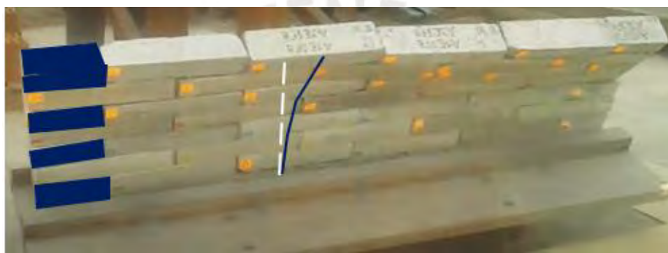
Figura 5.4 Forma de falla para A1V1 (los bloques azules representan las filas en donde se ubican las 'piedras' pasantes)
