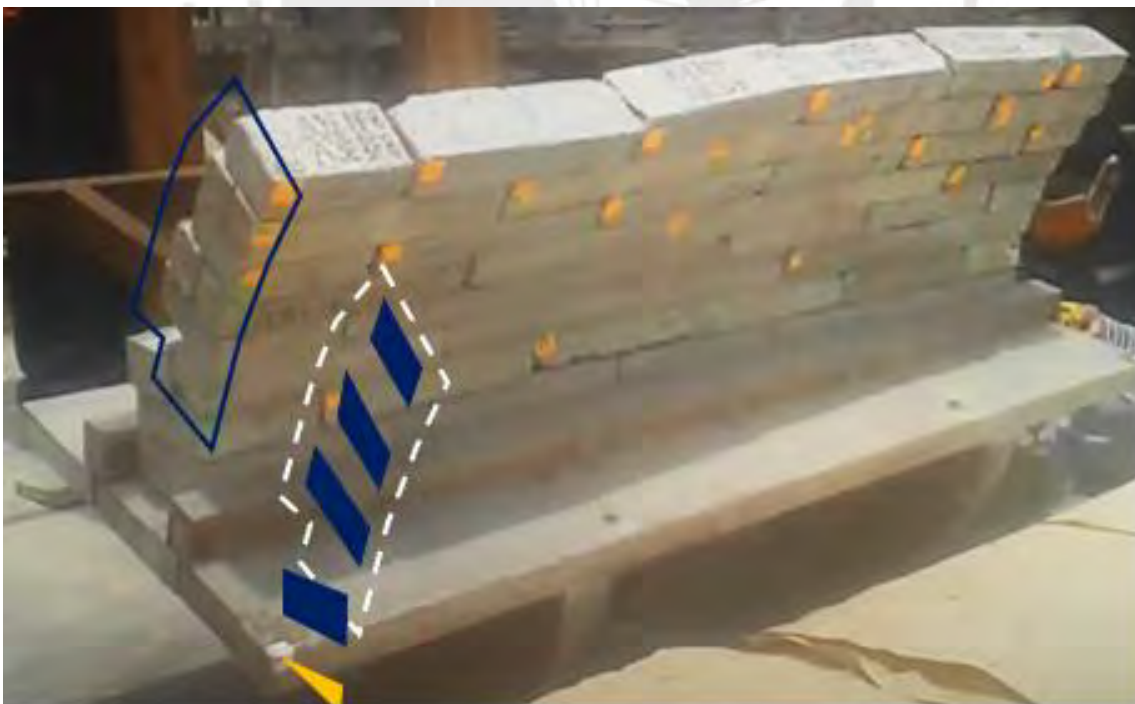
Figura 5.20 Forma de falla para A3V2 (los bloques azules son las 'piedras' pasantes y la cuña anaranjada muestra la pendiente de la base de 10.3^\circ )
