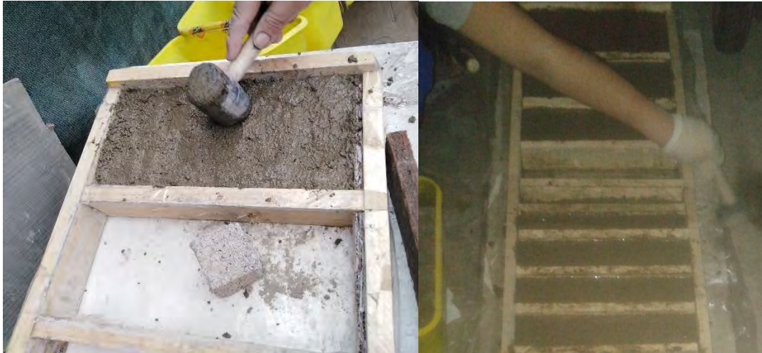
Figura A4 Vaciado y compactación de concreto
