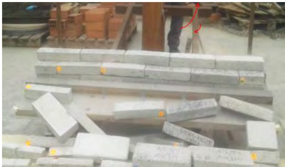
Figura 5.21 Vista frontal de A3V1 (P3) (las flechas en rojo indican el movimiento de la mesa generada por la caída)
