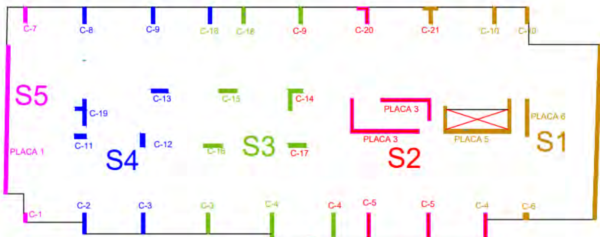
Figura 17. Sectorización de acero para piso típico
