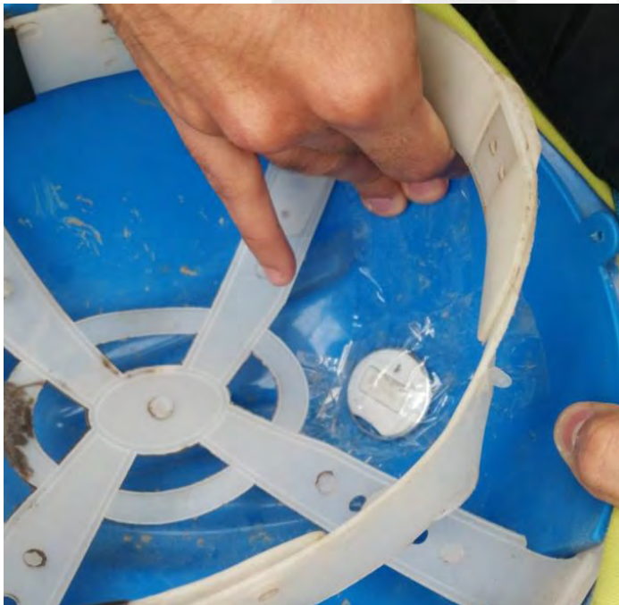
Figura 24. Colocación de sensor detrás del casco
