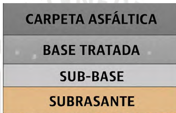
Figura 4: Capas del pavimento semirrígido.
