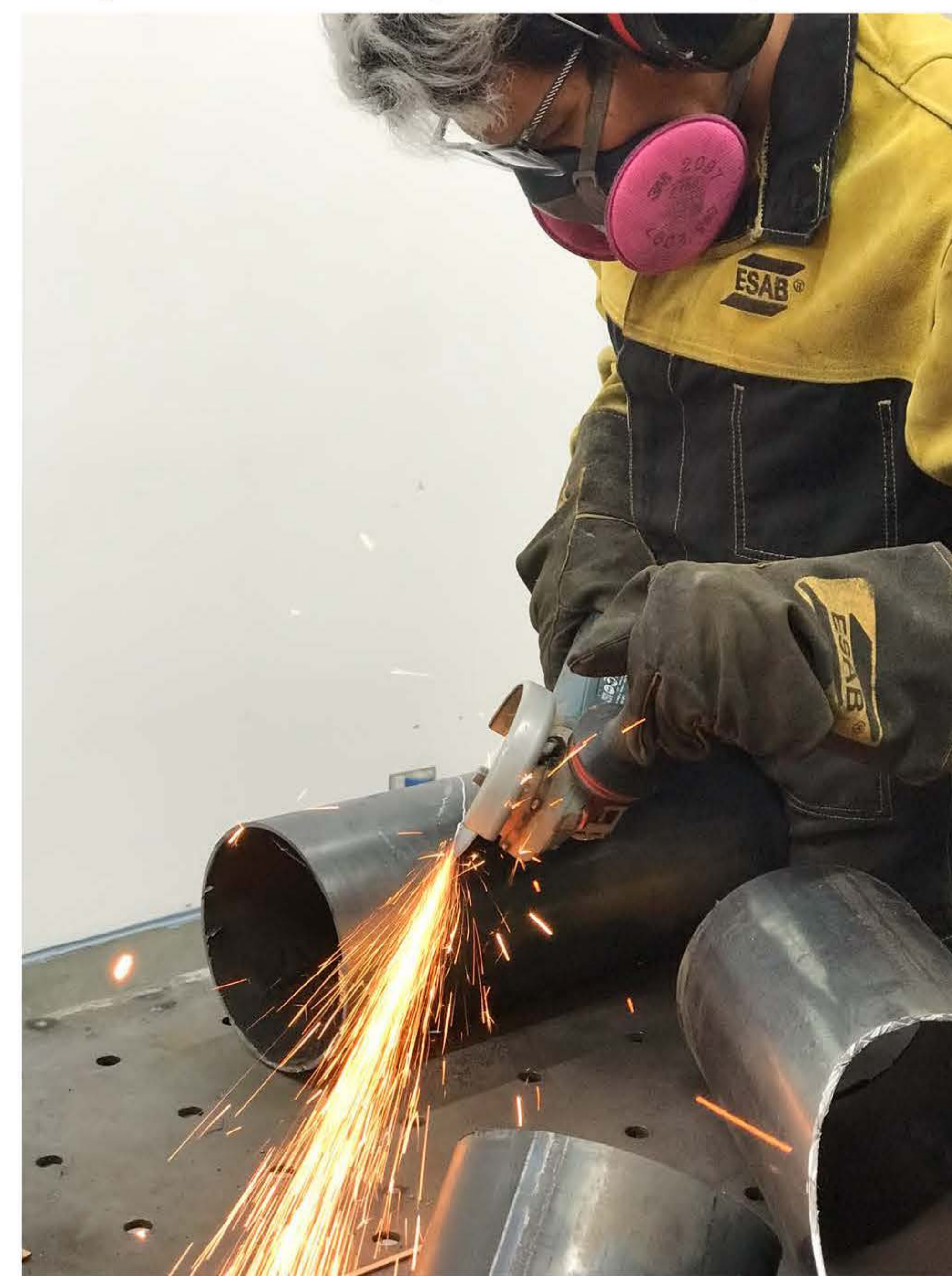
SOLDADURA se afinan los cortes para soldar las piezas
