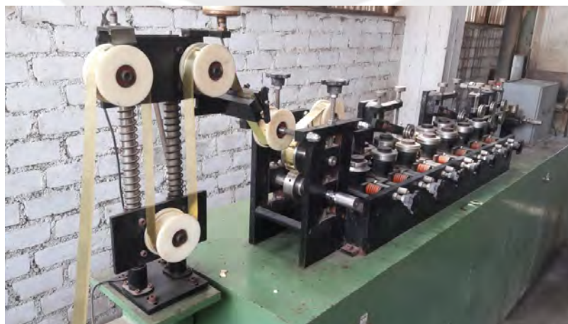
FIGURA 15: SISTEMA DE DOBLADO DEL TUBO (TUBERA)
