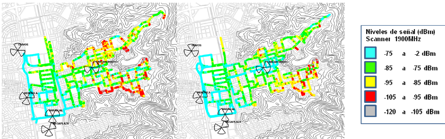
Figura 47: Drive test antes y después de entrar en servicio la BTS Tahuantinsuyo en la banda de 1900MHz
