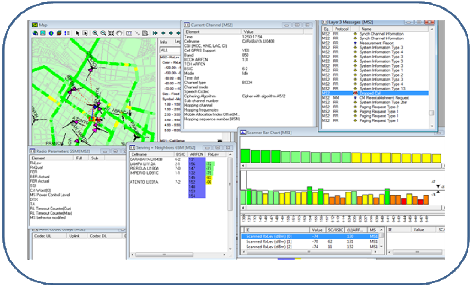
Figura 28: Imagen de captura que muestra el momento en que la llamada se cayó y el equipo pasa a estado Idle
