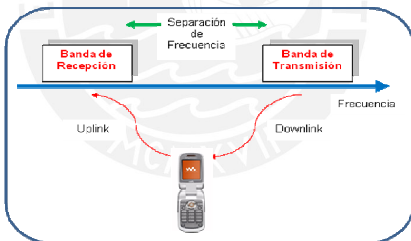
Figura 3: Duplexaje FDD para una comunicación celular [4]
