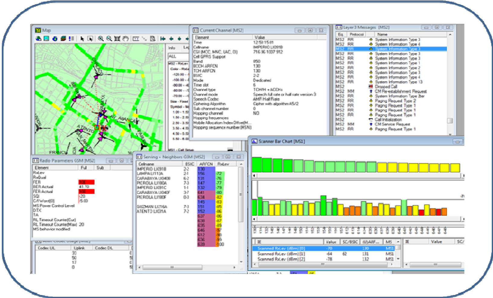
Figura 27: Imagen de captura que muestra que el celular no responde los mensajes, que hay interferencia y un FER muy elevado antes de que se caiga la llamada
