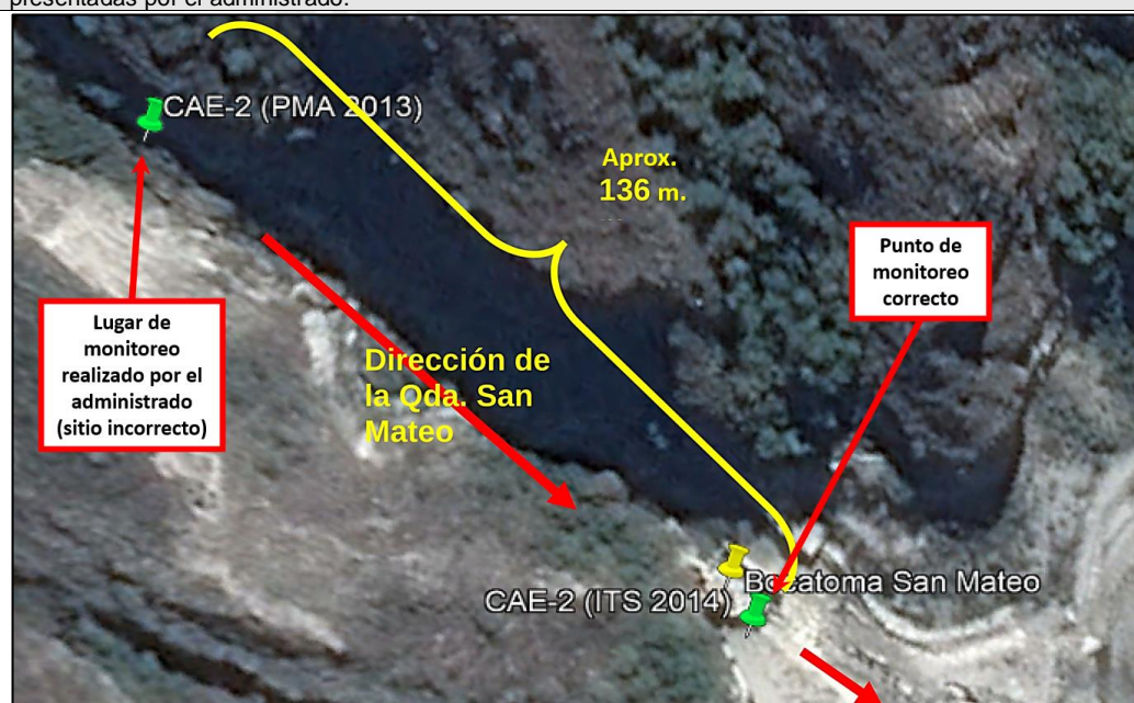
Imagen N° 2: Imagen Google Earth donde se muestra en color verde el punto de Caudal Ecológico aprobado en el PMA 2013 (CAE-2 [PMA 2013]) y el aprobado en el ITS 2014 (CAE-2 [ITS 2014]). Asimismo, se muestra la ubicación de la bocatoma San Mateo en color amarillo.
