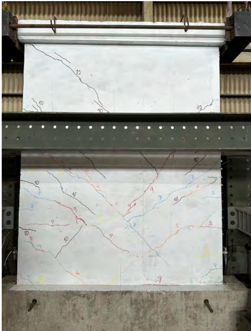
Figura 5.16. Fase 10 (Fisuras de 1.00 mm de espesor) – Amplitud 12.50 mm
