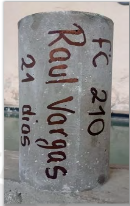
Figura 2.21. Izq. Probeta estándar de diseño para 17.5 MPa de diseño (21 días). Der. Probeta estándar de diseño para 21 MPa (21 días)
