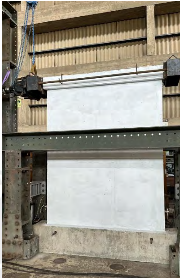
Figura 5.8. Fase 02 (No fisuras) – Amplitud 0.9 mm
