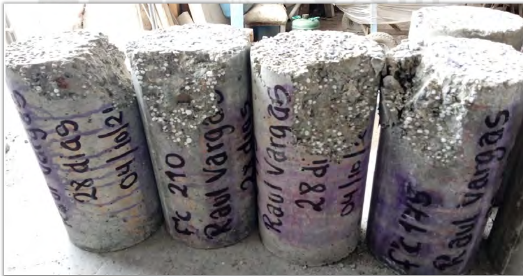
Figura 2.27. Fin de ensayo para probetas estándar - 17.5 y 21 MPa (28 días)
