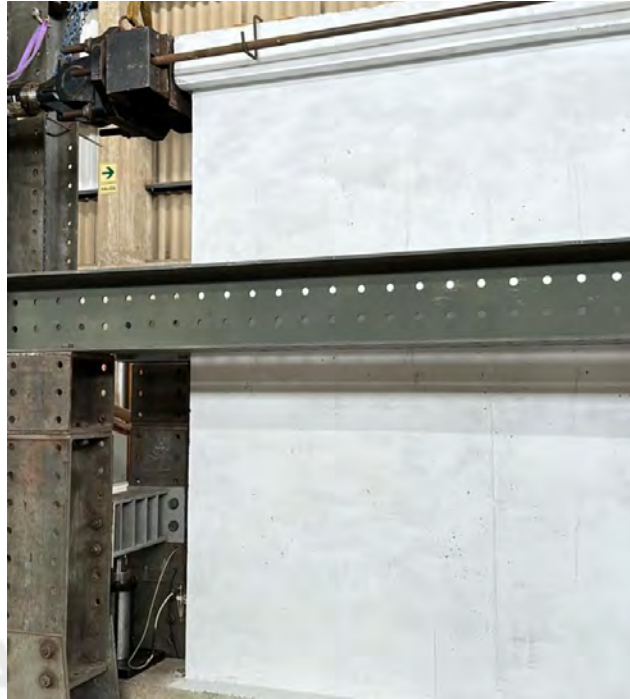
Figura 5.9. Fase 03 (No fisuras) – Amplitud 1.10 mm
