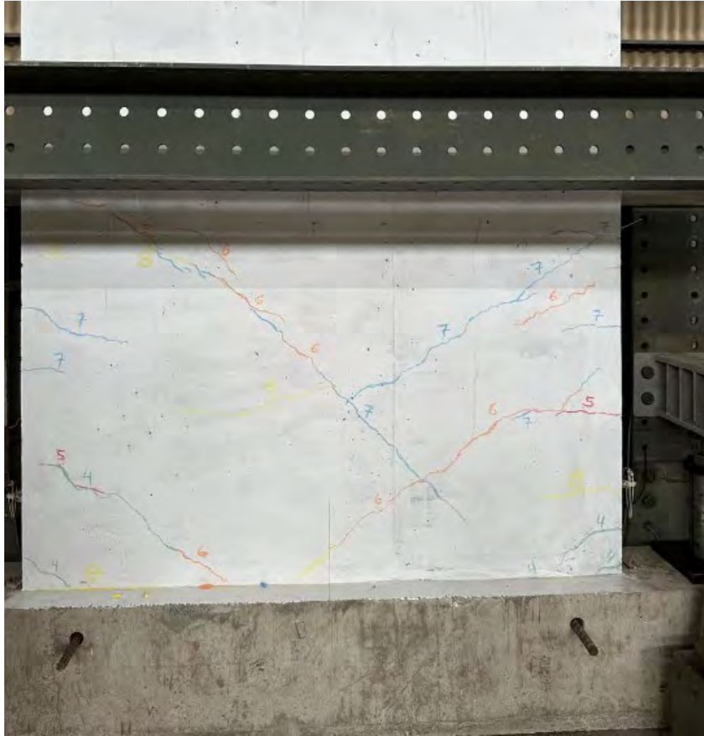
Figura 5.14. Fase 08 (Fisuras de 0.5 mm de espesor)– Amplitud 6.30 mm
