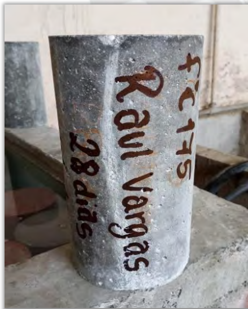
Figura 2.22. Izq. Probeta estándar de diseño para 17.5 MPa de diseño (28 días). Der. Probeta estándar de diseño para 21 MPa (28 días)
