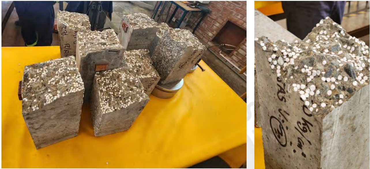
Figura 4.7. Vigas hechas a base de concreto ligero de resistencia a la compresión de 17.5 Mpa y 21 Mpa luego de prueba módulo de rotura (ASTM C78)
