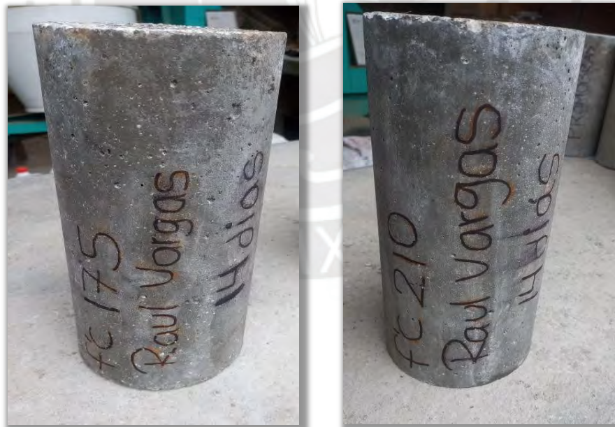
Figura 2.20. Izq. Probeta estándar de diseño para 17.5 MPa de diseño (14 días). Der. Probeta estándar de diseño para 21 MPa (14 días)
