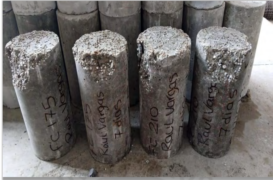
Figura 2.24. Fin de ensayo para probetas estándar - 17.5 y 21 MPa (7 días)
