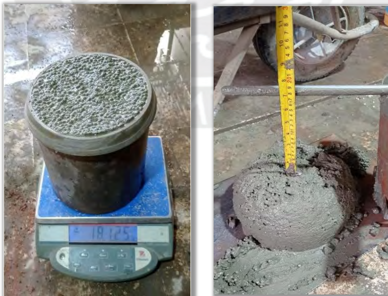
Figura 2.18. Izq. Control de peso del concreto ligero. Der. Medición de consistencia
