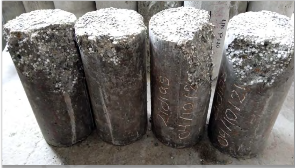
Figura 2.26. Fin de ensayo para probetas estándar - 17.5 y 21 MPa (21 días)
