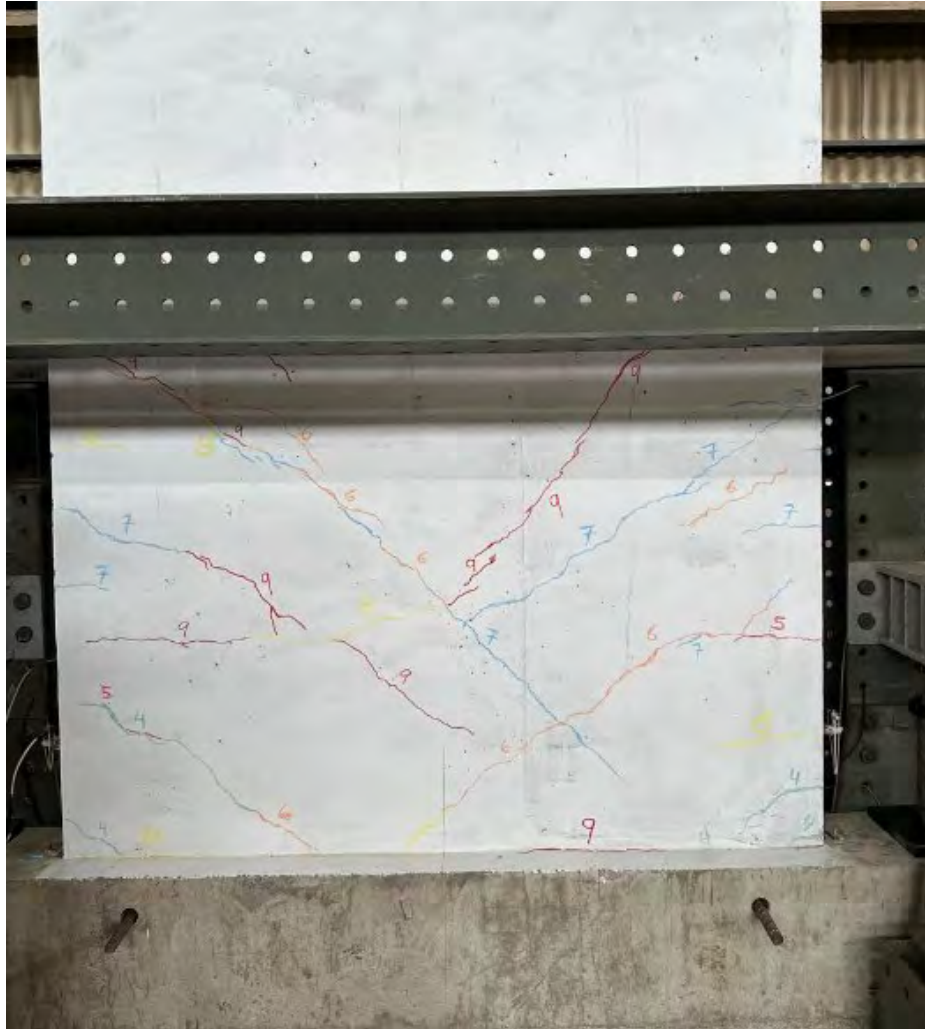
Figura 5.15. Fase 09 (Fisuras de 0.6 mm de espesor) – Amplitud 8.90 mm
