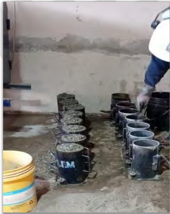
Figura 2.16. Elaboración de probetas de 17.5 y 21 MPa– Fuente propia
