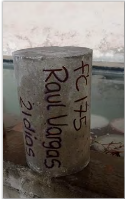
Figura 2.21. Izq. Probeta estándar de diseño para 17.5 MPa de diseño (21 días). Der. Probeta estándar de diseño para 21 MPa (21 días)
