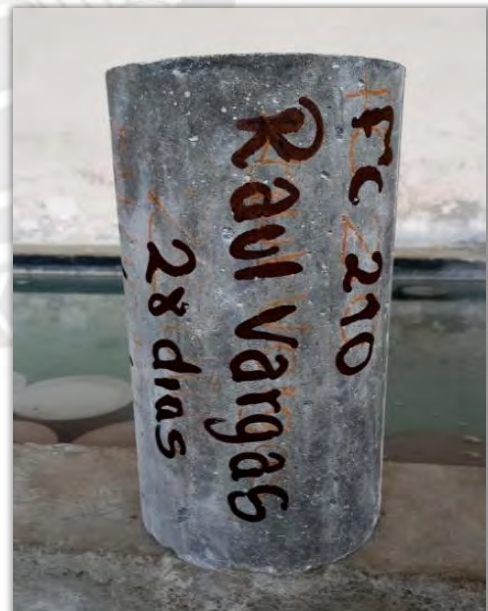
Figura 2.22. Izq. Probeta estándar de diseño para 17.5 MPa de diseño (28 días). Der. Probeta estándar de diseño para 21 MPa (28 días)
