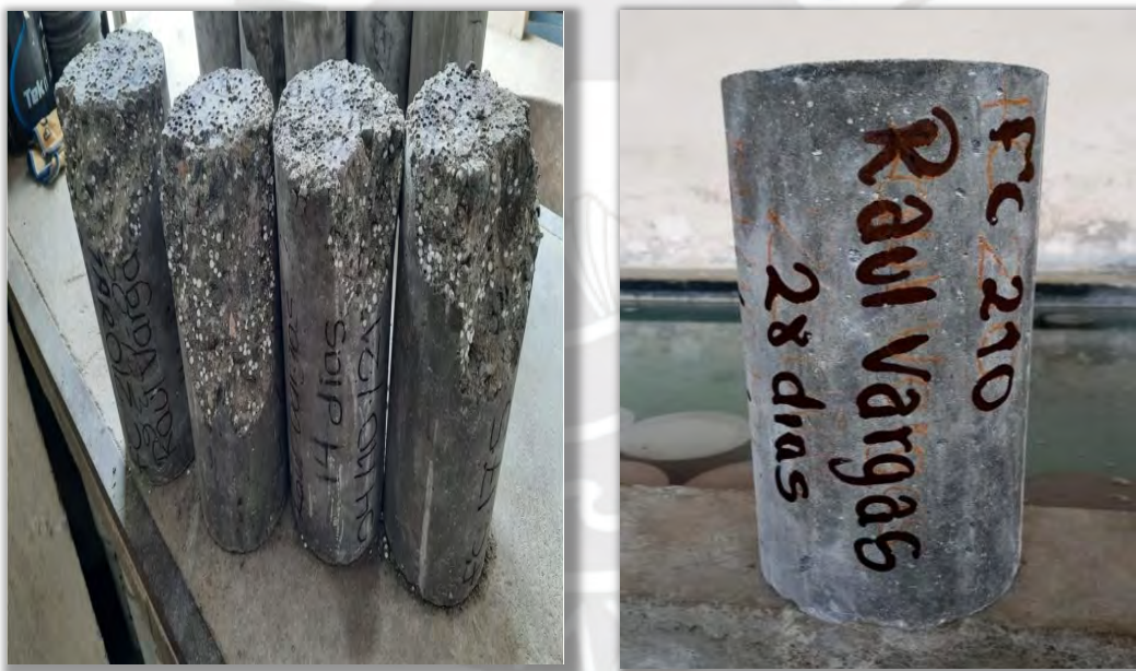
Figura 3.2. Probetas para ensayo de módulo de elasticidad - ASTM C469
