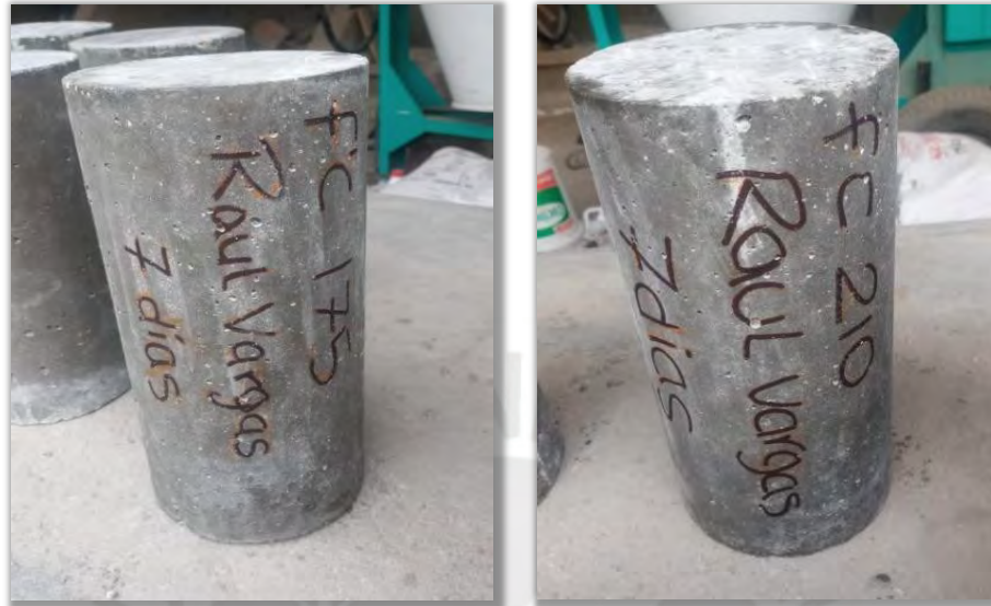
Figura 2.19. Izq. Probeta estándar de diseño para 17.5 MPa de diseño (7 días). Der. Probeta estándar de diseño para 21 MPa (7 días)
