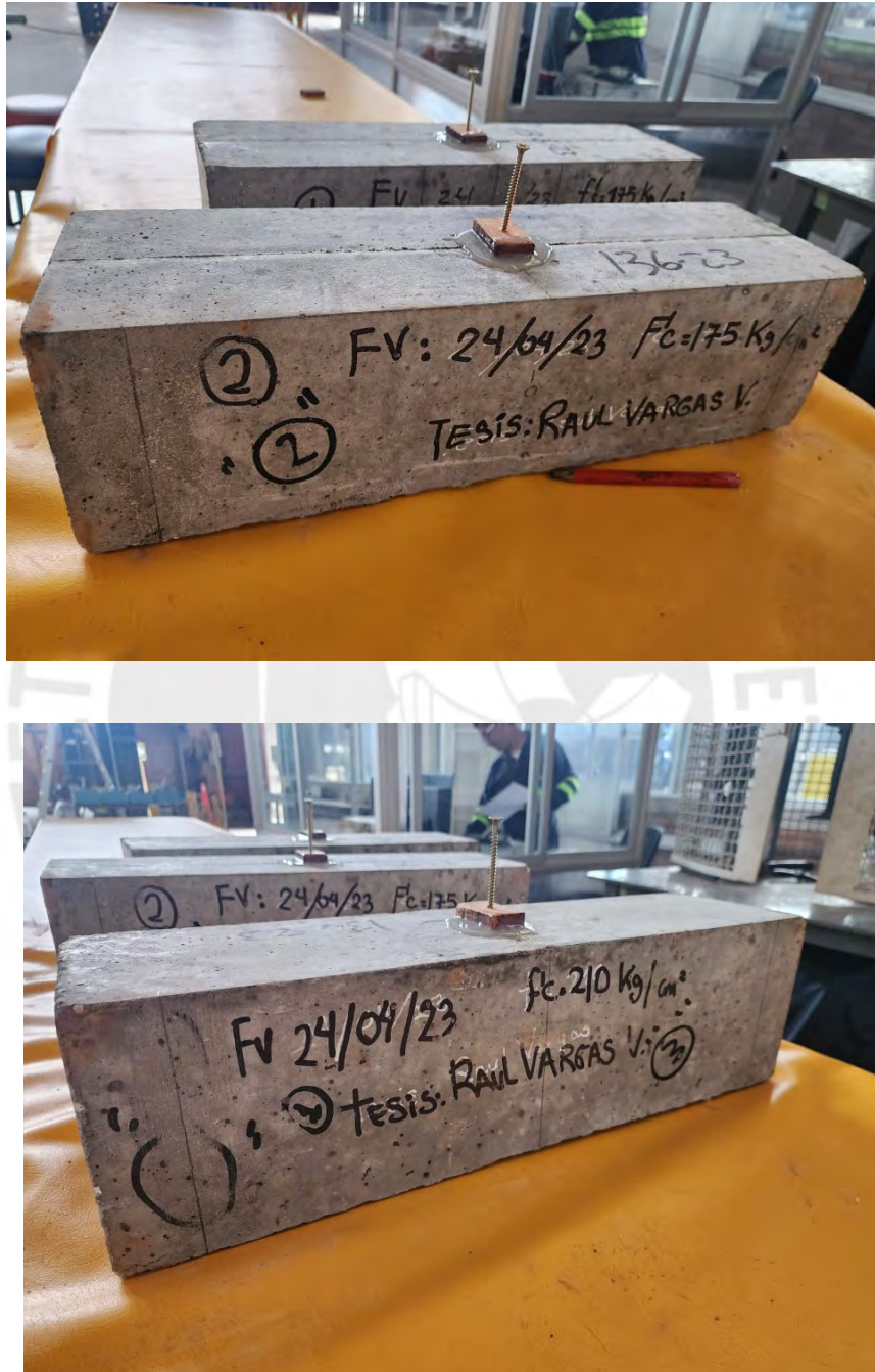
Figura 4.6. Vigas hechas a base de concreto ligero de resistencia a la compresión de 17.5 MPa y 21 Mpa para prueba módulo de rotura (ASTM C78)
