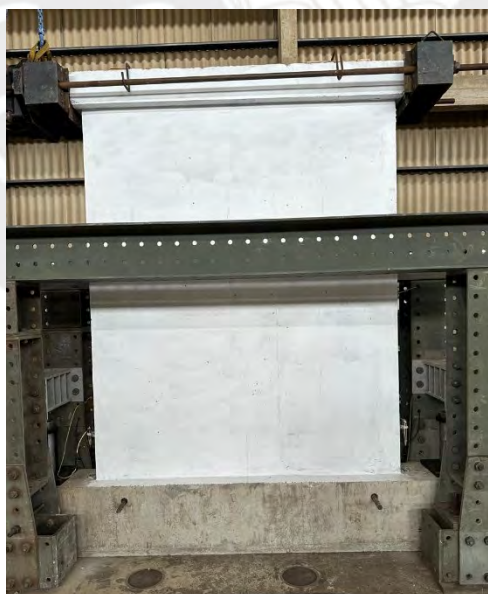
Figura 5.7. Fase 01 (No fisuras) – Amplitud 0.5 mm
