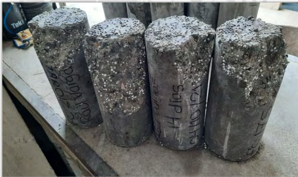
Figura 2.25. Fin de ensayo para probetas estándar - 17.5 y 21 MPa (14 días)
