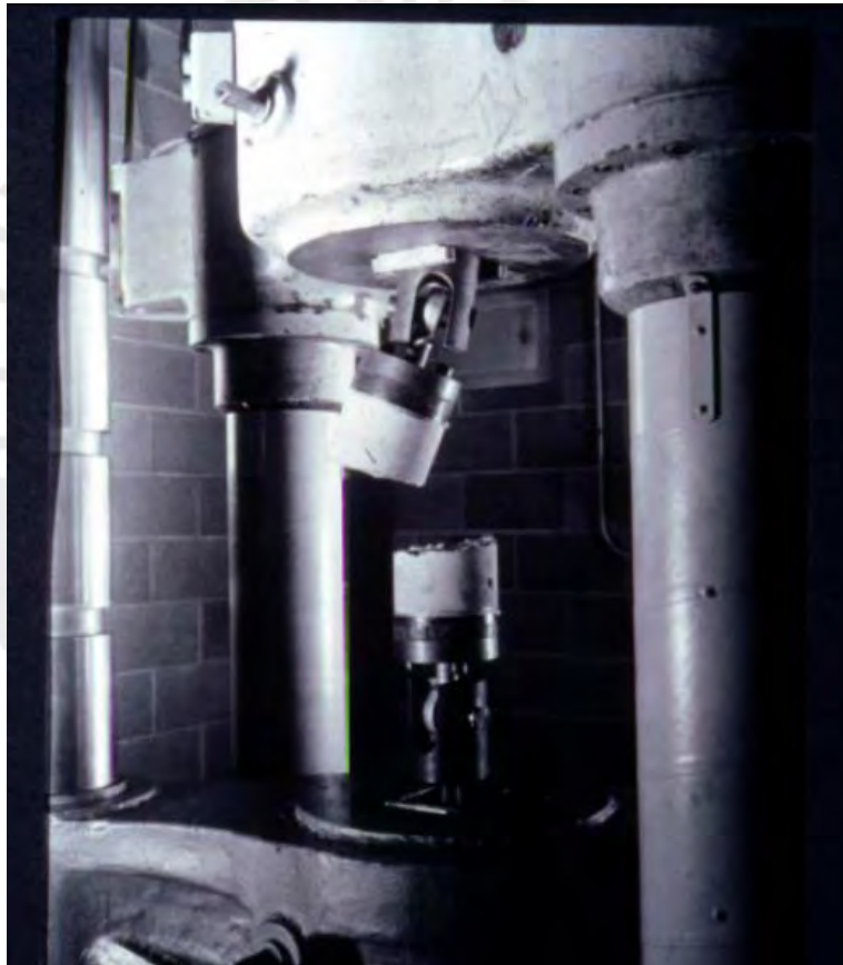
Figura 4.1. Prueba de tracción directa – Materiales de Construcción PUCP
