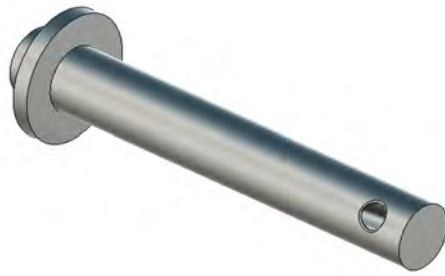
Figura 2.34. Pasadores de los apoyos fijos del actuador hidráulico
