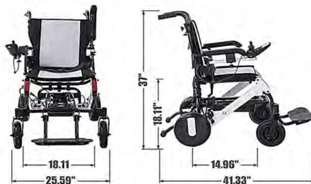
Figura 1.2. Dimensiones estándar de una silla de ruedas eléctricas 1
