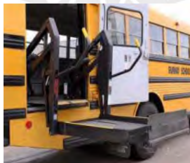
Figura A14. Mecanismo de brazos articulados [Vizcaino, 2018]
