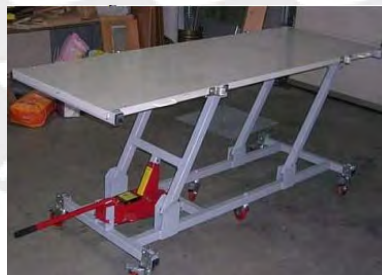
Figura A11. Mecanismo de 4 barras [Hernández, 2016]
