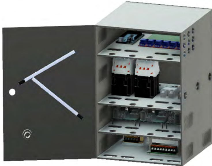
Figura 3.19. Disposición interna del panel de control
