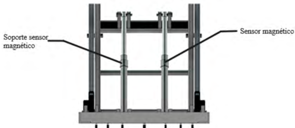
Figura 4.4. Disposición de los sensores de campo magnético
