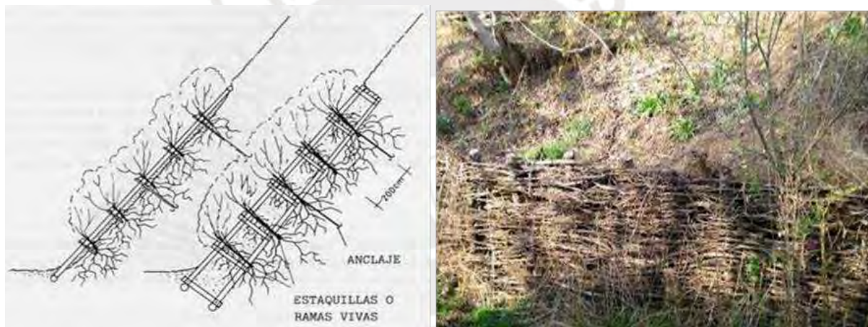
Figura 73: Aplicación de empalizadas trenzadas para el reforzamiento de taludes
