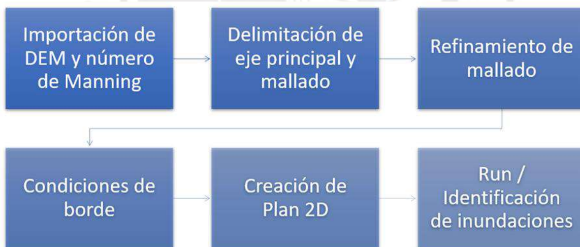
Figura 18: Pasos para el modelamiento hidráulico en el programa HEC-RAS
