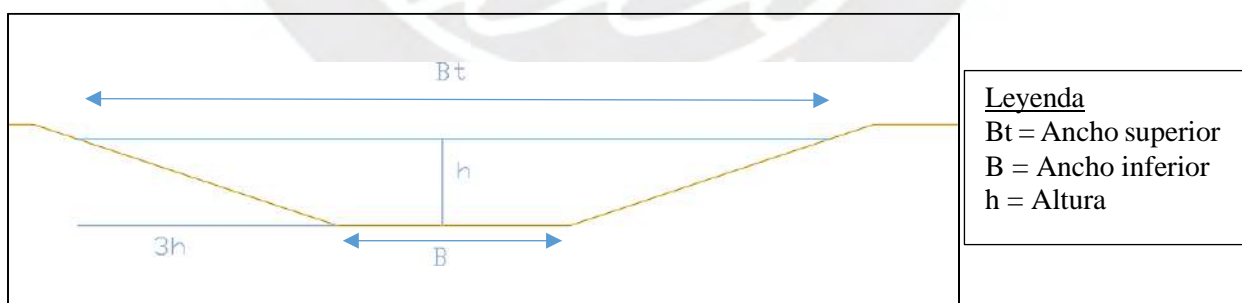
Figura 63: Sección simplificada del cauce
