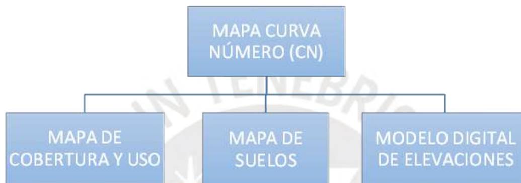
Figura 9: Modelo conceptual para la generación de la curva número CN
