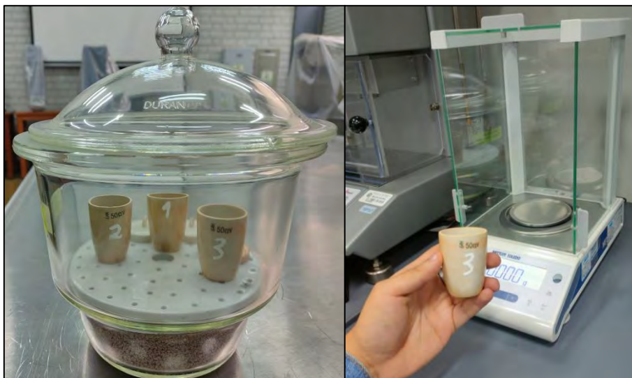
Figura 2.11. Des humificación de los crisoles para posterior pesado en báscula para el ensayo de masas residuales en las telas de PP
