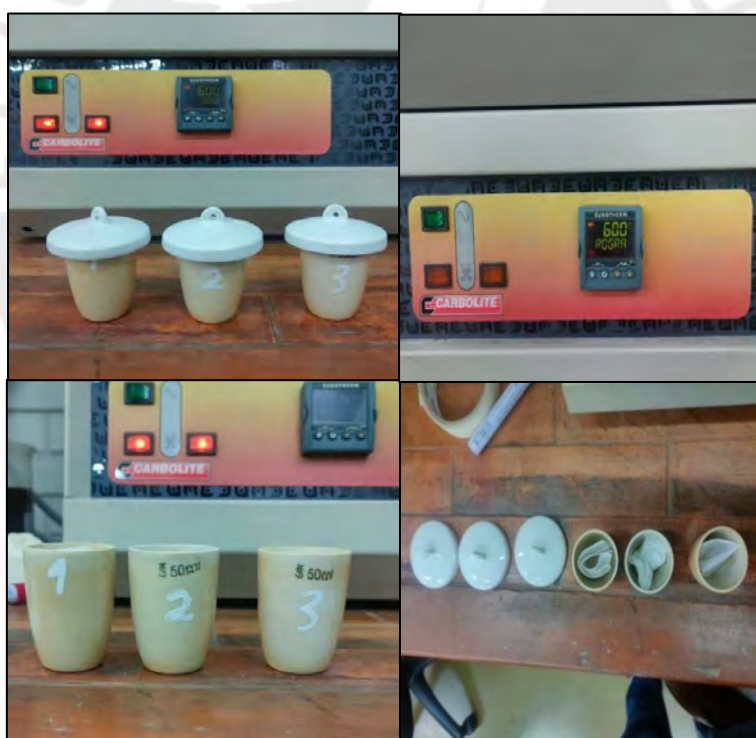
Figura 2.10. Muestras de PP colocadas en el horno eléctrico a 600C°
