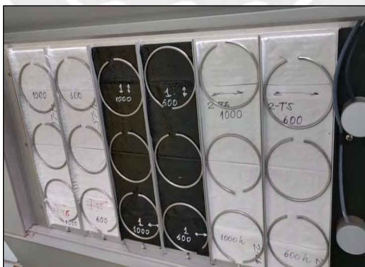
Figura 2.2. Muestras de telas de polipropileno en la cámara de radiación UV
