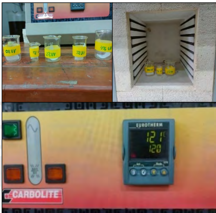
Figura 3.15. Eliminación de tensiones internas de telas de PP a una temperatura de 120C° durante un periodo de 5 minutos
