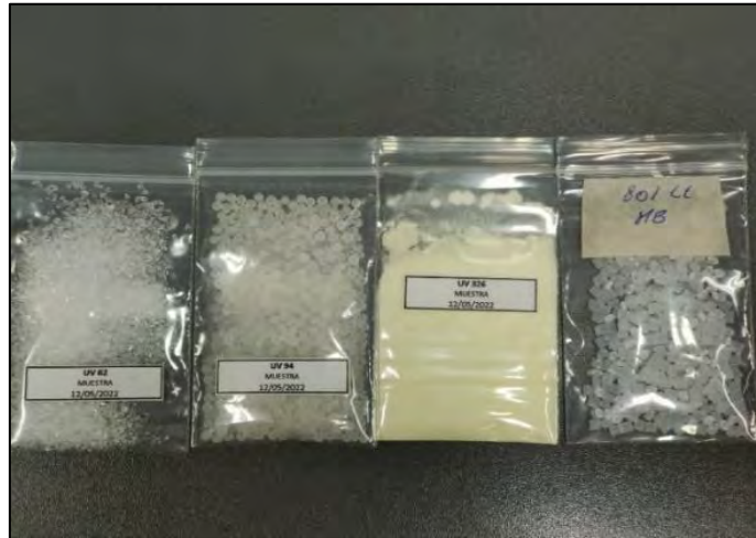
Figura 1.14. Aditivos anti-UV (UV-62, UV-94, UV-326, 801 LL-MB) empleados en la formulación de las telas tejidas de Polipropileno.
