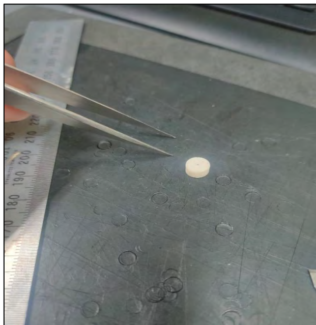
Figura 2.5. Preparación de las muestras de PP en los crisoles de Alúmina o óxido de aluminio ( \text{Al}_2\text{O}_3 ) empleados en el ensayo de termogravimetría (Crisol de referencia y muestra para el análisis TGA)
