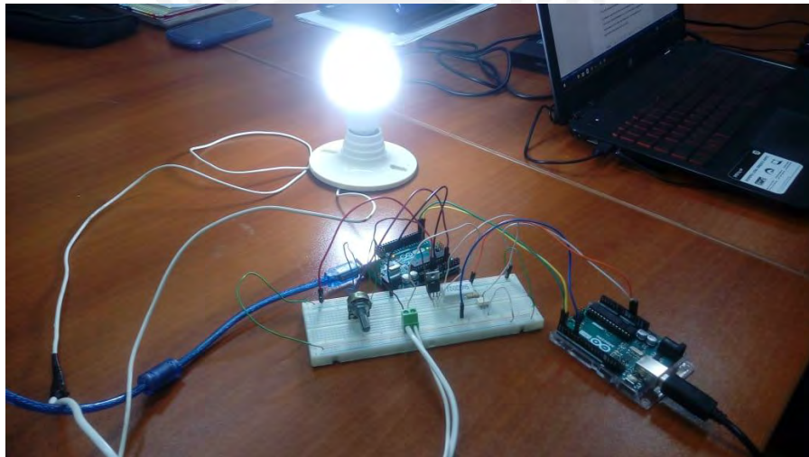
Figura 35: Imagen del encendido del foco al tener una señal de oxígeno disuelto menor a 5mg/L
