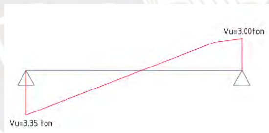
Figura 36. Fuerza Cortante Viga Chata 1.4CM+1.7CV
