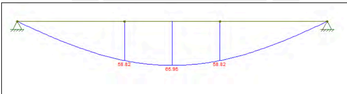
Figura 84. Distribución de momento flector para viga solera. (Fuente:propia)
