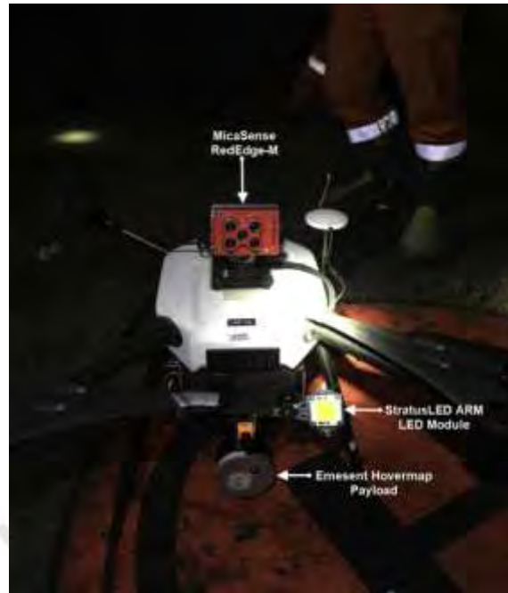
Fig. 1 Dron DJI Win 2 con montaje de la cámara MicaSense RedEdge-M e incluido el LiDAR para usar el sistema Emesent Hovermap [2]
