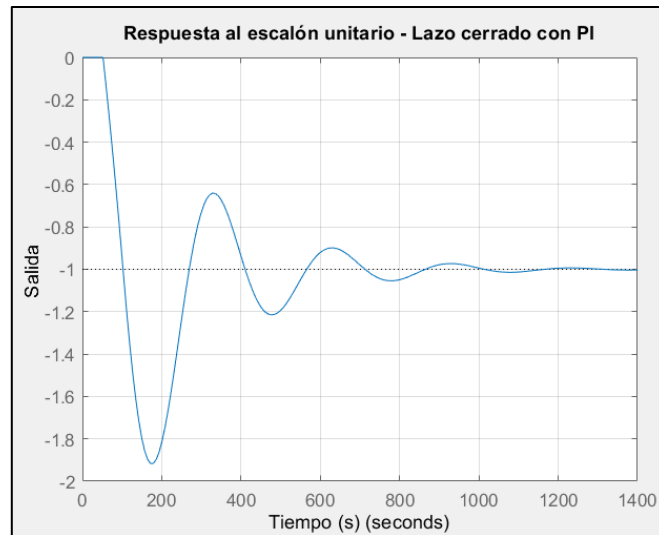
Figura K7: Primera prueba de respuesta al escalón unitario
