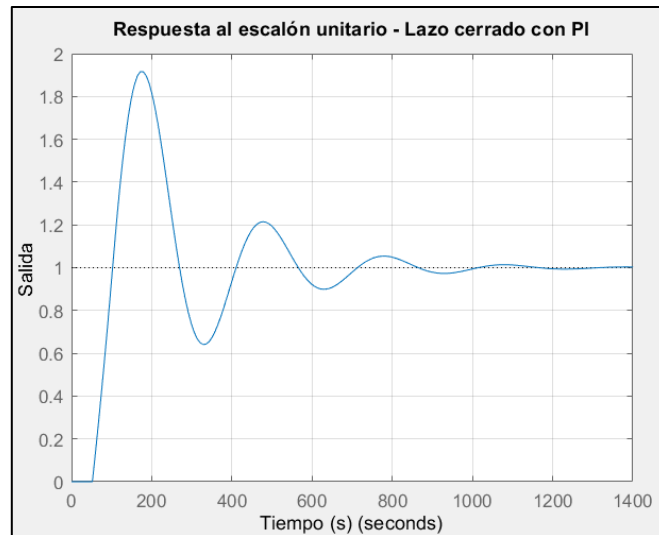
Figura K5: Primera prueba de respuesta al escalón unitario
