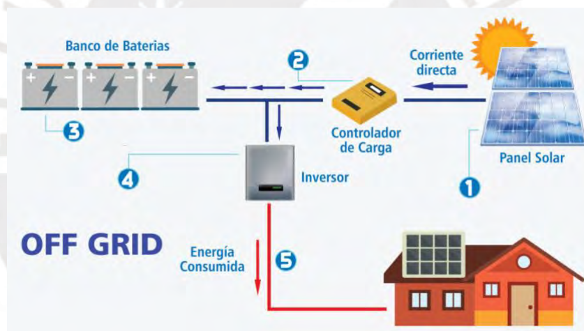
Figura 5: Sistemas Fotovoltaicos Off-Grid[23]
