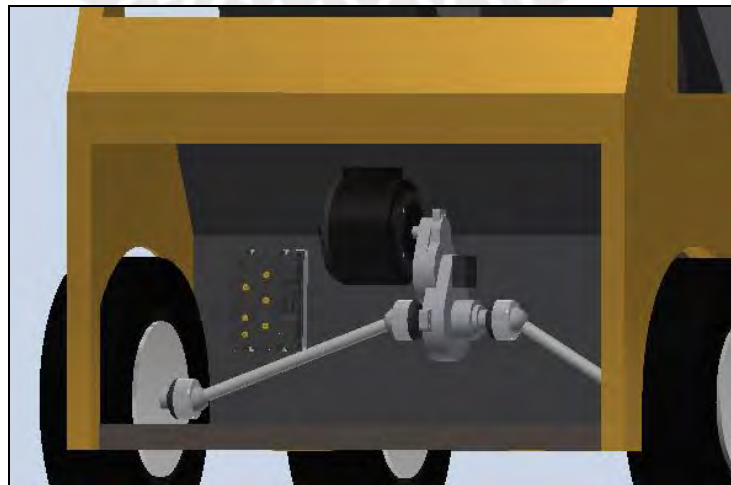
Figura 5.9: Colocación esperada de los componentes de propulsión en el vehículo Fuente: Elaboración propia
