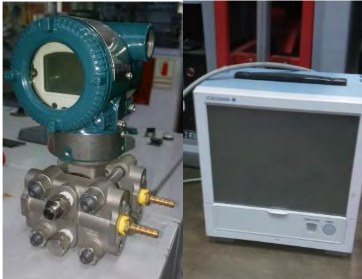
Figura 37 - Instalación de registrador y cambio de medidor diferencial de presión Dwyer 477 por YOCOGAWA modelo E110A.
