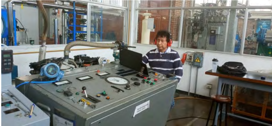
Figura 13 - Módulo de control del Dinamómetro.
