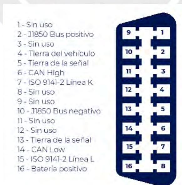
Figura 2 - Descripción de terminales OBD2.
