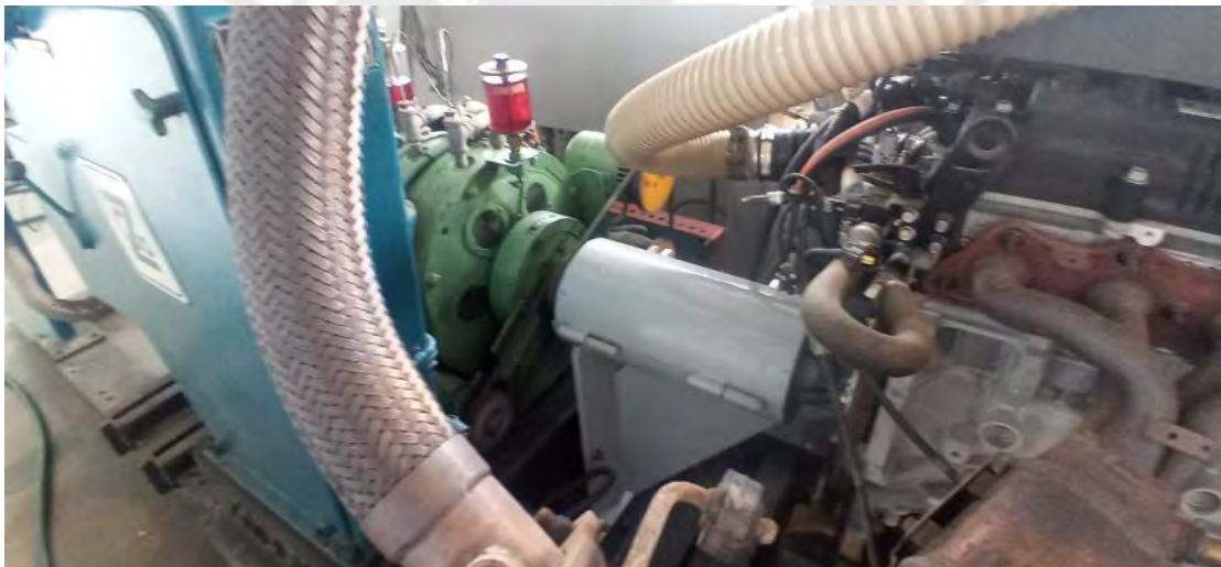
Figura 27 - Detalle de conexión entre motor y dinamómetro mediante eje cardan.
