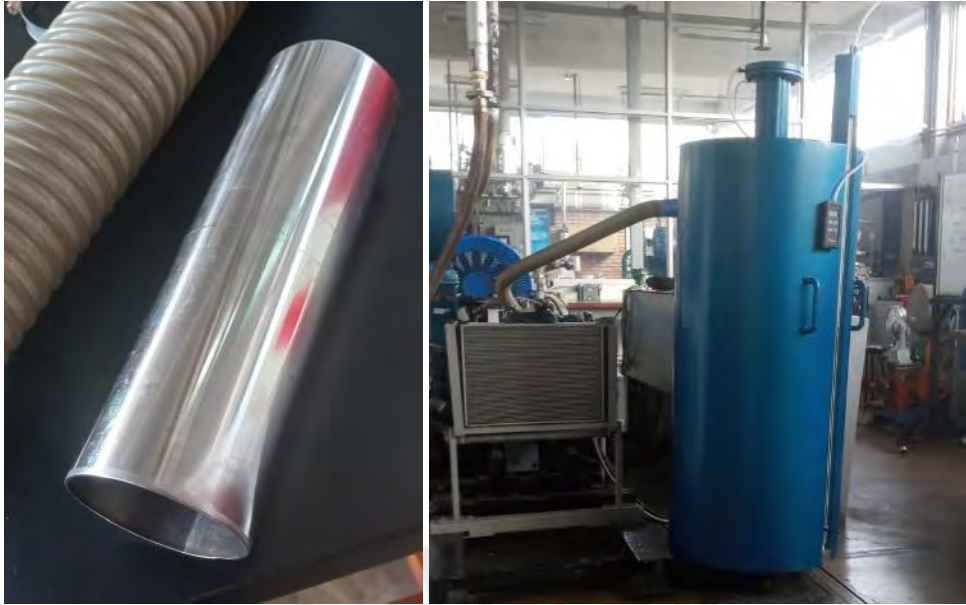
Figura 24 - Accesorios de conexión y medidor del flujo de aire de admisión al motor.
