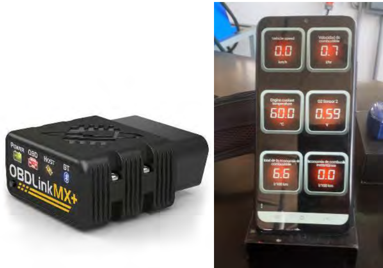
Figura 32 - Dispositivo OBDII conectado a telefono celular vía aplicativo para captura de datos en tiempo real.
