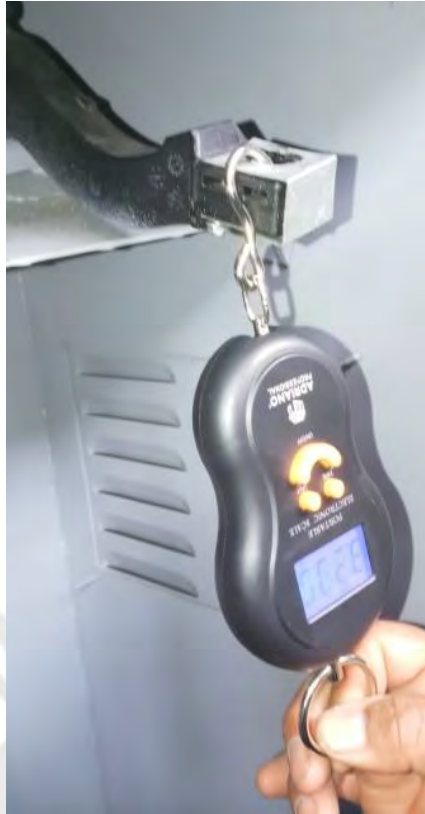
Figura 33 - Medición de fuerza para mover pedal de acelerador.
