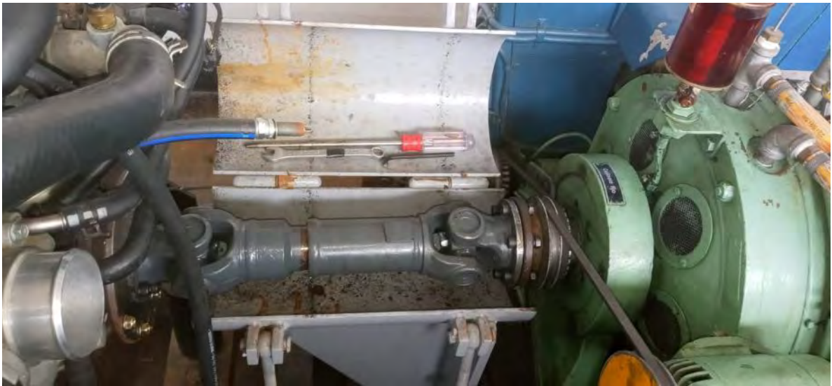
Figura 15 - Dinamómetro conectado al motor con un eje cardan
