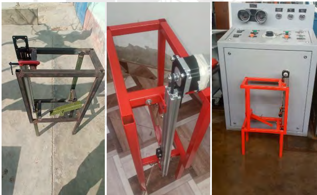
Figura 35 - Proceso de fabricación y uso del soporte del actuador y controlador del pedal.
