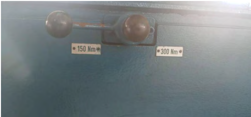
Figura 28 - Dinamómetro en el rango de inferior con un máximo de 150 Nm.
