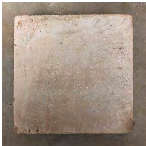
Bloque fraguado, para exponer el grano de la mezcla se añade agua y se lija para retirar la capa superficial del concreto
