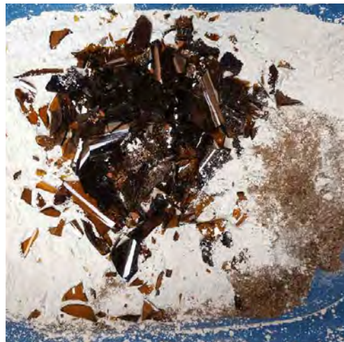
Restos de vidrio oscuro, estos se rompen en distinto tamaño para tener variedad de grano en la mezcla.
