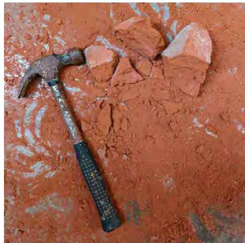
Restos de ladrillo, estos se rompen en distinto tamaño para tener variedad de grano en la mezcla.
