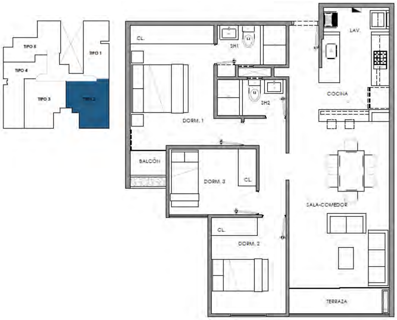
Figura 8.13 Planta tipología 2 Fuente: Edificaciones Inmobiliarias Modificación propia
