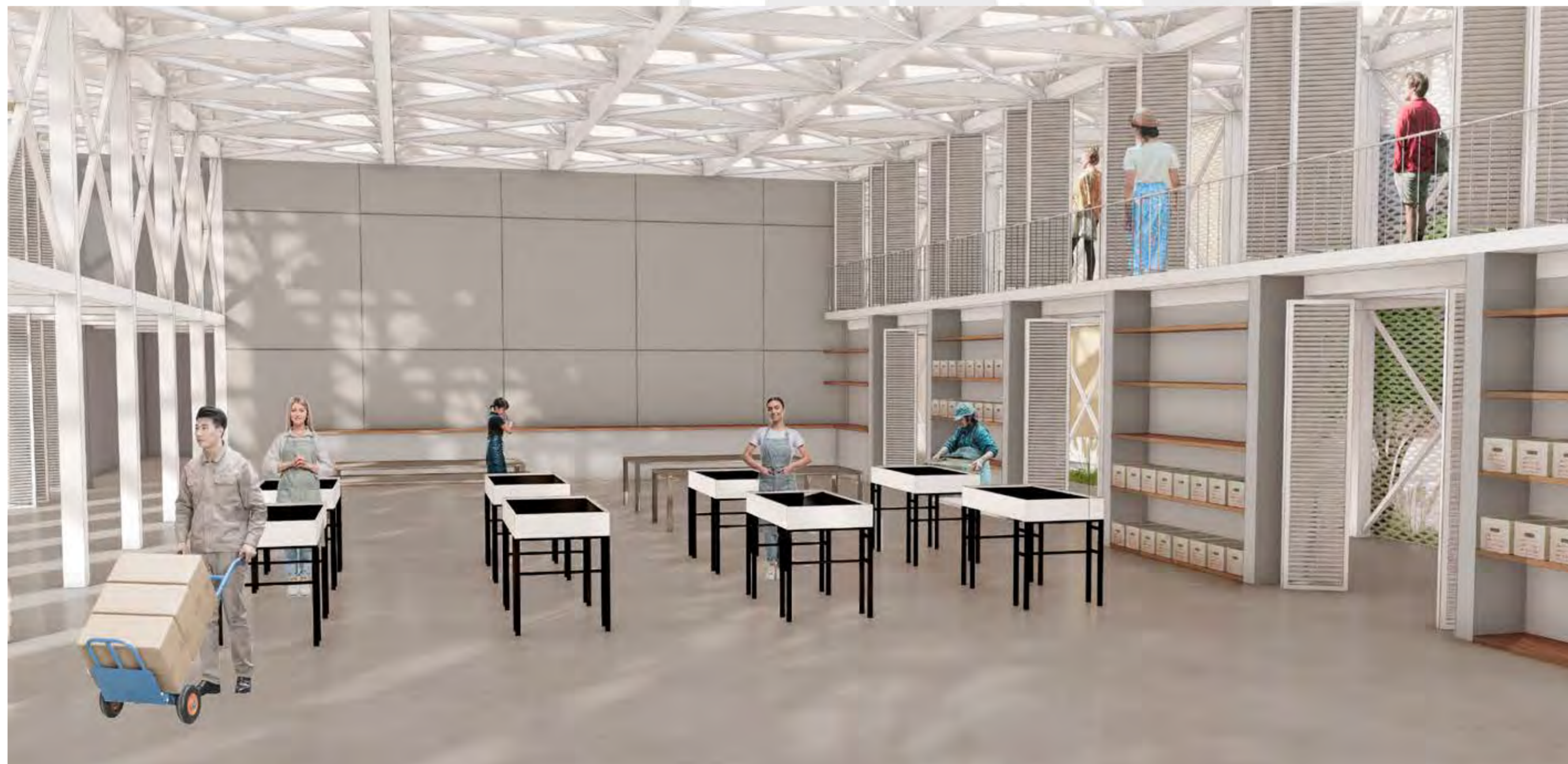
Vista interior del bloque artesanal, donde se fabrican productos como hojas, cuadernos y etiquetas a partir del reciclaje de papel. En primer plano, las tinas de acero contienen el papel remojado como parte del proceso de transformación. Sobre el área de trabajo, una pasarela elevada permite a los visitantes observar el desarrollo de las distintas etapas de producción sin interferir en ellas. La fachada de malla expandida filtra la luz natural, generando una iluminación difusa en el interior, mientras que las mamparas corredizas posibilitan la conexión con el exterior al abrirse.
