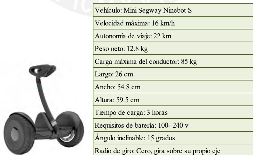
Figura 2.15: Características técnicas del Mini Segway-Ninebot S Fuente: Segway, 2020.
