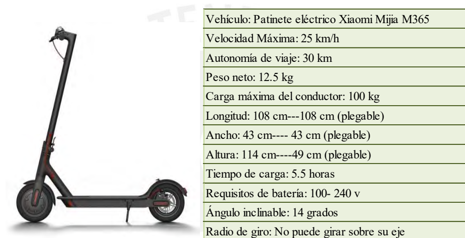
Figura 2.16: Características técnicas del patinete eléctrico – Xiaomi Mijia M365 Fuente: Xiaomi, 2020.
