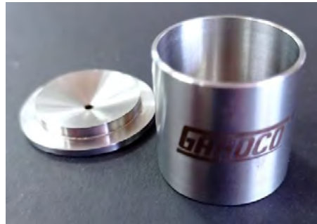
Figura 12. Picnómetro de acero inoxidable GARDCO de aproximadamente 8,32 mL de capacidad.
