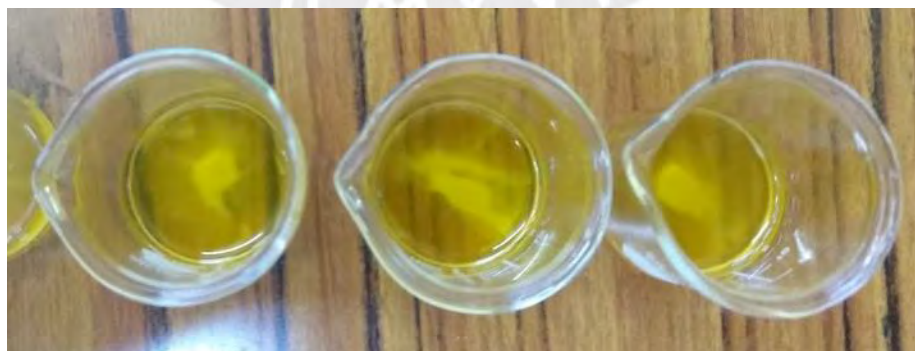
Figura 25. Tres últimas pruebas de solubilidad para la primera etapa de la síntesis de Li70Alc-02. Luego de 11 horas no se observó la disminución en la cantidad de sólidos.
