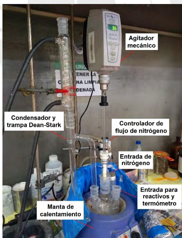
Figura 15. Sistema de reacción para la síntesis de resinas alquídicas por acidólisis y por alcoholólisis.
