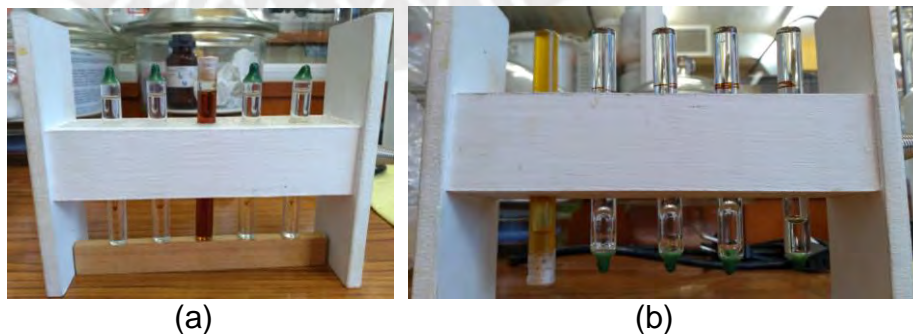
Figura 18. Determinación del rango de viscosidad. (a) Los tubos con los estándares y el tubo con la resina se colocan en un soporte a una misma altura. (b) Se invierte el soporte y se compara los tiempos de ascenso de las burbujas con ayuda de un cronómetro.
