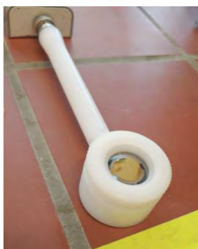
Figura 22. Disco de cristal de cuarzo en el soporte de la microbalanza de cristal de cuarzo. Se ha depositado una muestra en el disco con ayuda del spin coater.
