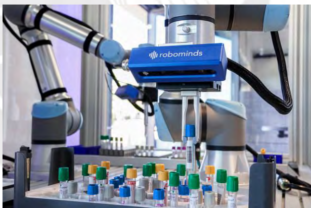
Figura A.7. Brazo robótico UR5e (Fuente: Robominds, 2024)
