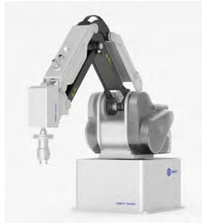
Figura 4.7. Brazo robótico Dobot MG400. (Fuente: Shenzhen Yuejiang Technology Co, 2023)
