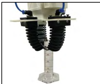
Figura A.12. Gripper en prueba de sujeción de tubo químico.
