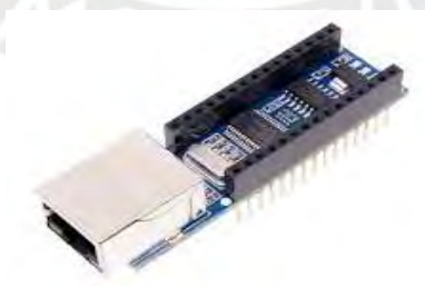
Figura 4.35. Módulo Ethernet para arduino Nano ENC28J60.
