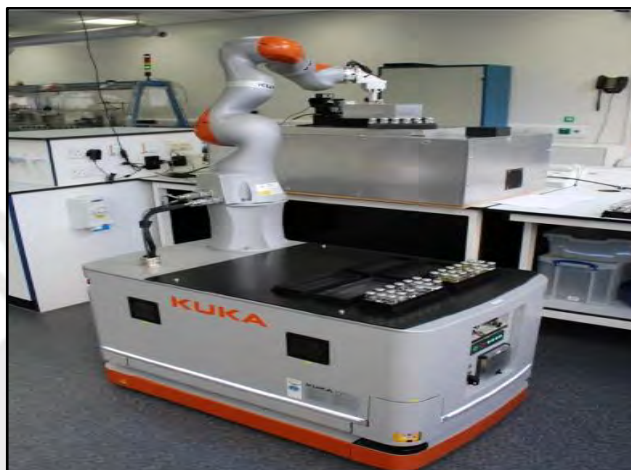
Figura A.4 Robotic Chemist manipulando muestras. (Fuente: Burger et al, 2020)
