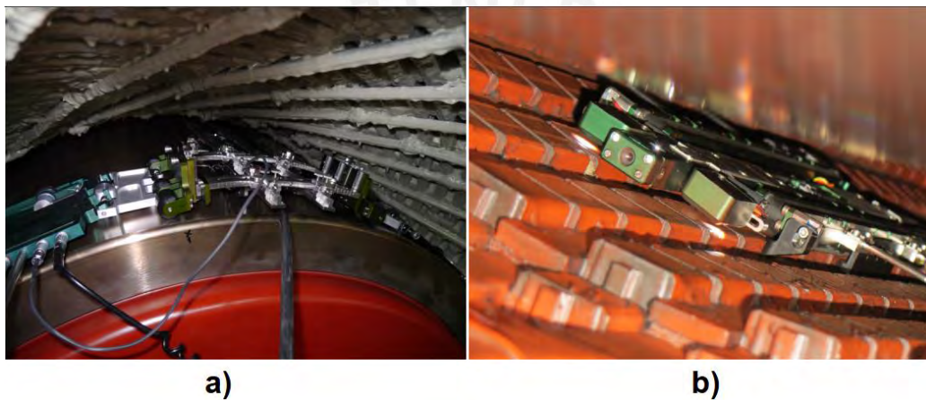
Figura 2.1. a) Riel del sistema acoplado al rotor b) Vehículo de inspección del generador
