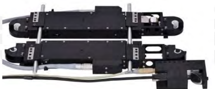
Figura 2.5. RIV - Cámara instalada para inspección lateral
