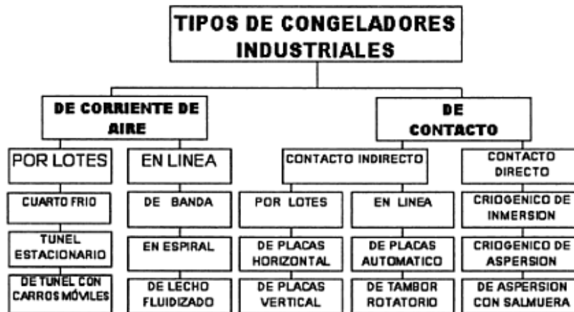
Figura 2. Clasificación de los congeladores industriales (Orrego, 2003)
