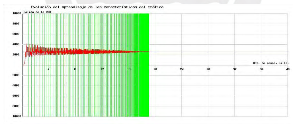
Figura 88. Proceso de aprendizaje con 200 muestras en 200 iteraciones para tráfico de intrusión al servicio SSH.
