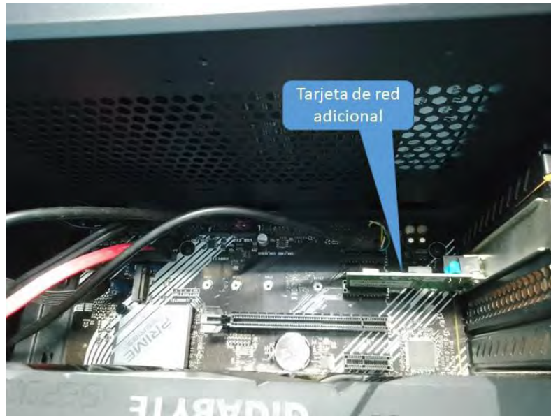
Figura 14. Instalación de tarjeta de red adicional.
