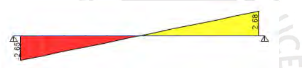
Figura 6-6. Fuerza cortante en la viga chata
