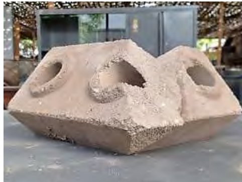
Figura 26. Moldeado de bloques ortogonales en las diagonales.
