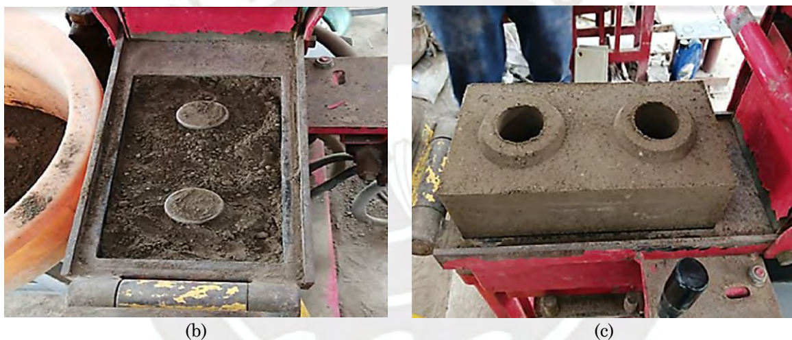
Figura 7. BTCs apilables (Huamani et al., 2022): (a) proceso de prensado, y (b) bloque terminado.
