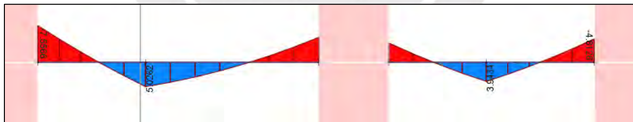
Figura 6.10 Diagrama de momento flector en servicio de la VT-01 (25X60)
