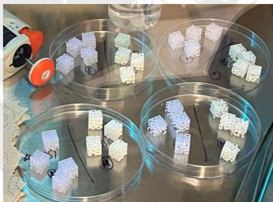
Figura 16. Andamios de 10x10mm
