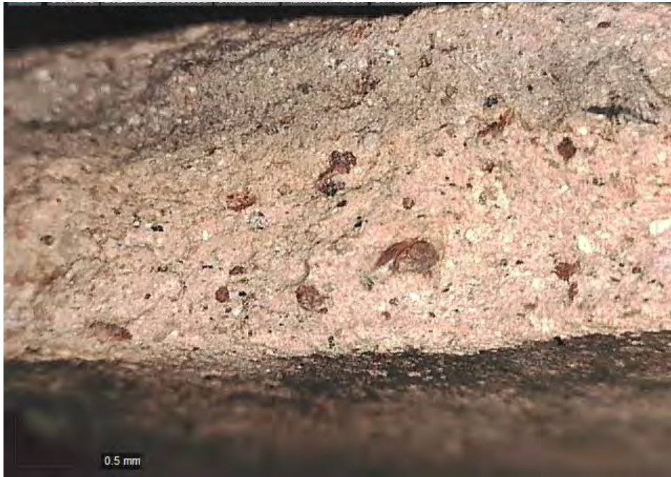
Figura 106. Pasta del tipo Habano bajo el microscopio, aumento 100x. (Fotografía: Tiepolo Fierro)
