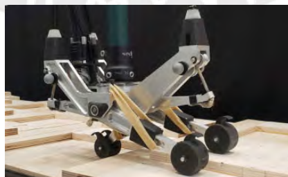
Figura 1.23: Prótesis para cancelar irregularidades mediante 3 dígitos [Chiu, 2021].
