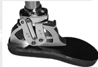
Figura 1.22: Prótesis adaptable a superficies inclinadas de forma pasiva [Nickel, 2014].
