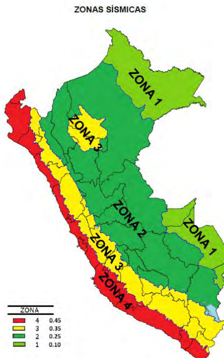
Figura 5.1.1. Zonas Sísmicas-Norma E.030
