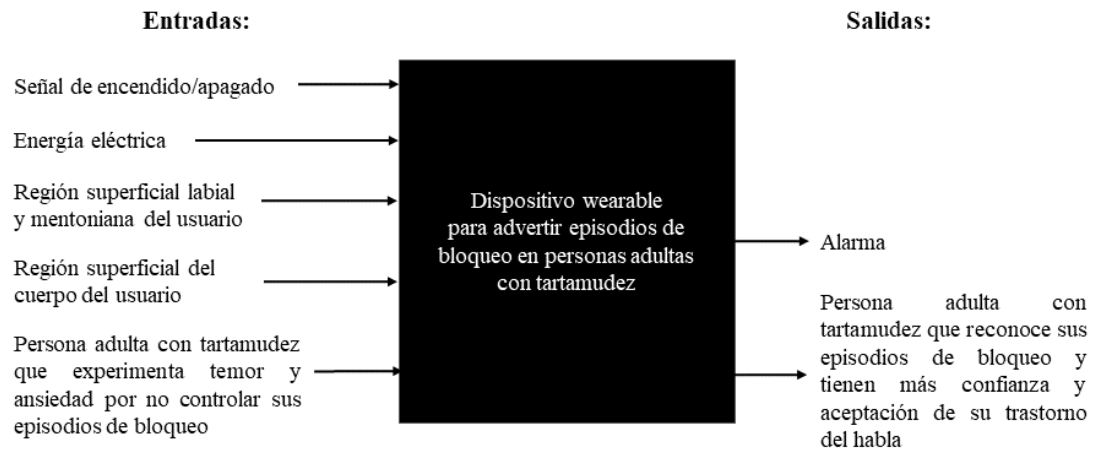
Figura 2.1: Esquema de caja negra del dispositivo asistencial de tartamudez
