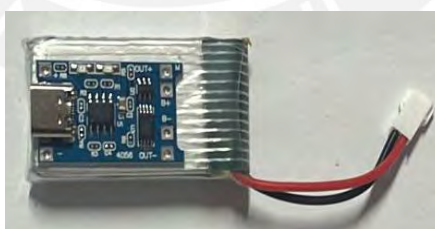
Figura 4.4: Módulo de carga TP4056-C con batería de 750 mAh
