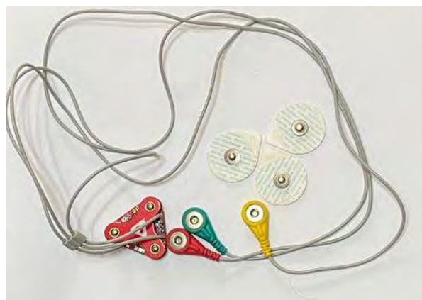
Figura 4.2: Conexión completa del sensor electromiográfico junto a los electrodos húmedos
