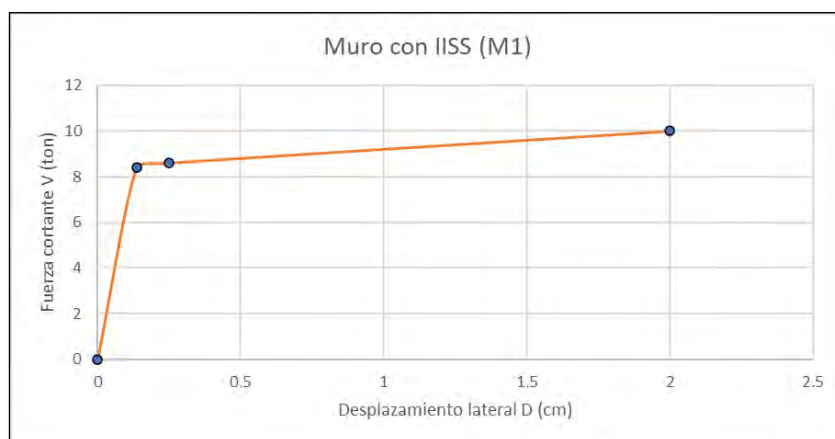
Figura 3.15a: Curva simplificada del muro M1
