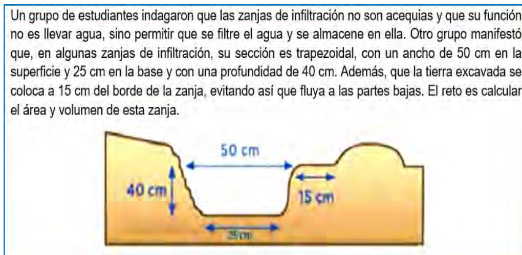
Figura 7. Problema sobre el cálculo del área y volumen de un prisma trapezoidal.
