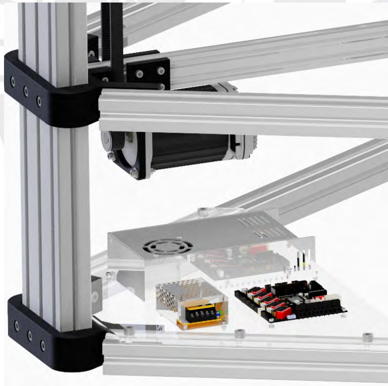
Figura 4.6 - Electrónica del sistema ubicada en la base (Fuente: Elaboración Propia)
