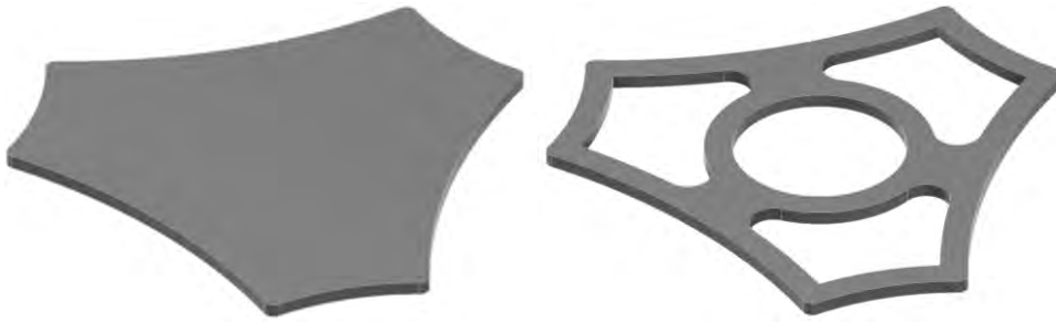
Figura 7.5 – (a) Forma del efector (b) Optimización de peso (Fuente: Elaboración Propia)
