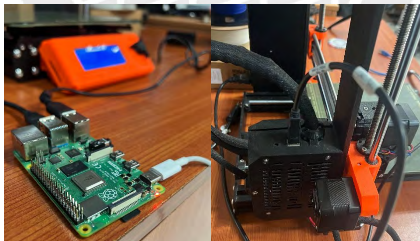
Figura I.5 - Conexión física entre Raspberry e impresora de prueba (Fuente: Elaboración propia)
