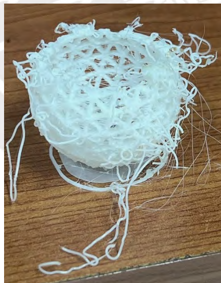
Figura 8.6 - Impresión con error detectada (Fuente: Elaboración Propia)
