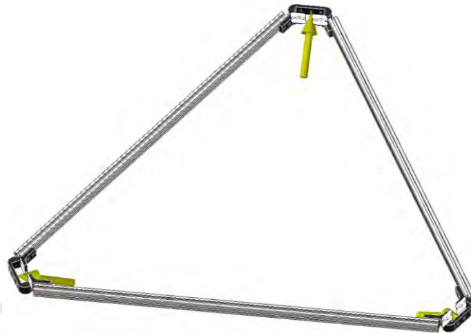
Figura D.8 - Distribución de fuerzas análisis de acoples laterales (Fuente: Elaboración propia)
