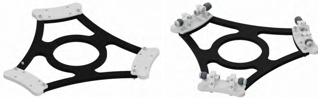
Figura 7.7 - Efector con acoples para mayor modularidad (Fuente: Elaboración Propia)
