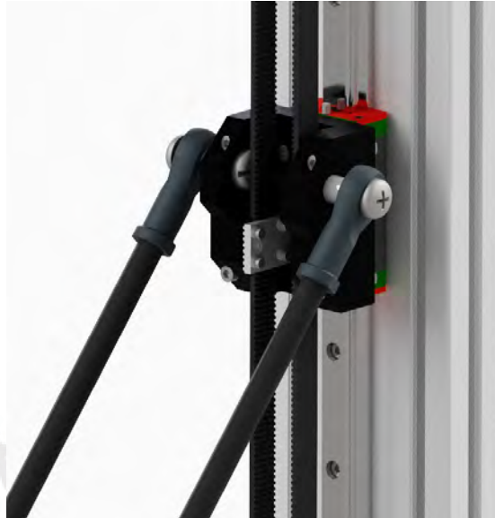
Figura 6.13 - Guía lineal y acople del subsistema de movimiento lineal (Fuente: Elaboración Propia)
