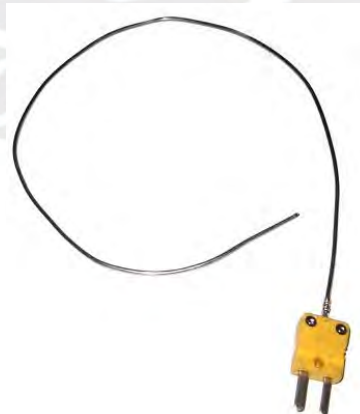
Figura 14. Termocupla Tipo K Marca Giva. Fuente Web Fabricante
