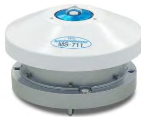
Figura 13. MS-711 Espectroradiómetro. Fuente Ficha Técnica
