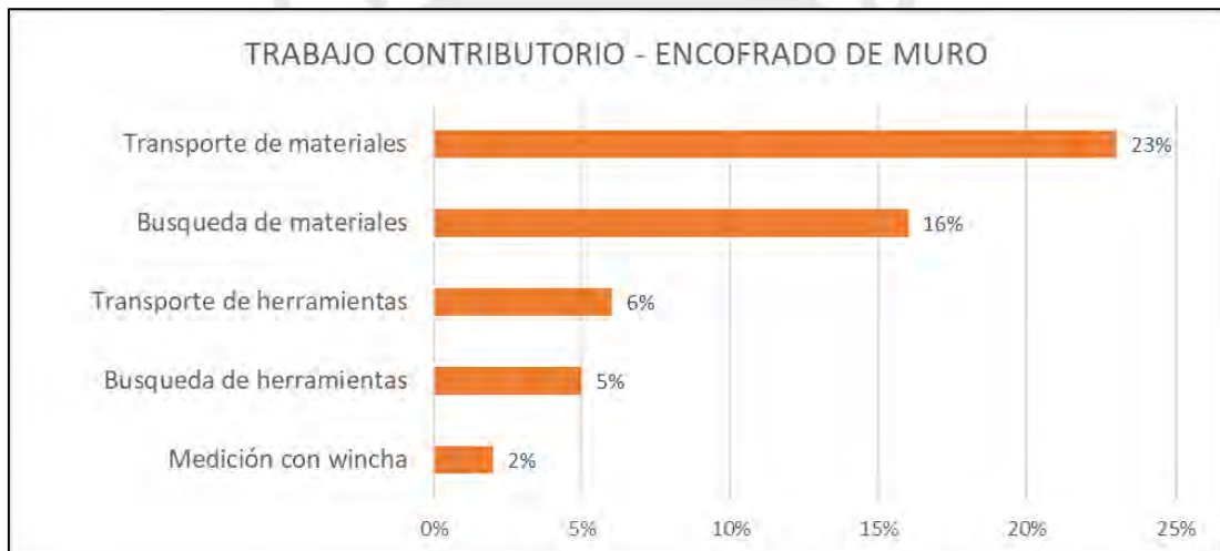
Figura 47: Resultados porcentajes parciales de los trabajos contributorios respecto al total en encofrado.
