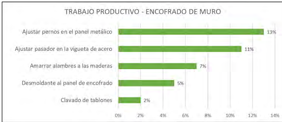
Figura 46: Resultados porcentajes parciales de los trabajos productivos respecto al total en encofrado.
