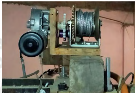
Figura 4.4. Motor de corriente continua con un sistema reductor de velocidad.
