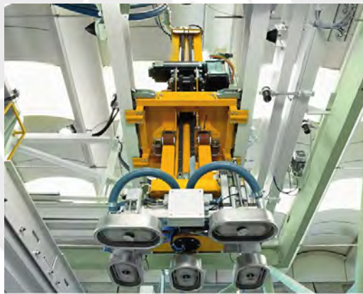
Figura 1.5. Sistema de cargado de bolsas de cemento mediante vacío. (FLSmidth, 2016)
