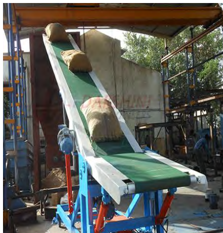
Figura 1.7. Sistema mecánico mediante fajas para elevación de productos.
