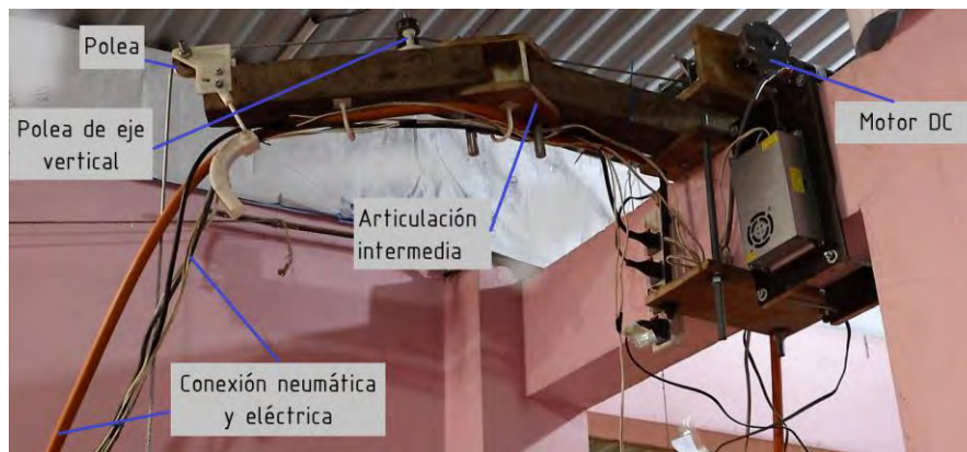
Figura 4.2. Brazo horizontal del sistema de elevación.
