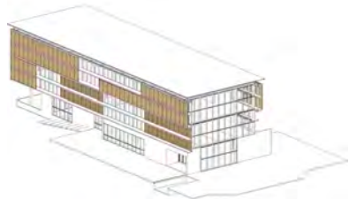
Fachada de totora para aislar el edificio del clima adverso (calor o frío).
