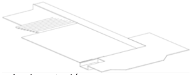
Losa de cimentación
