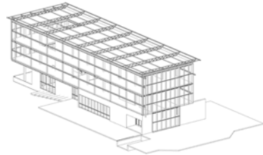
Estructura ligera de cerchas metálicas.
