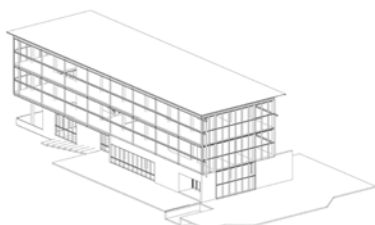
Doble techo metálico
