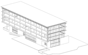
Sistema de pasarelas para facilitar el mantenimiento de las fachadas.
