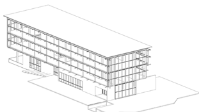
Estructura para fachada con ménsulas sujetadas de vigas.
