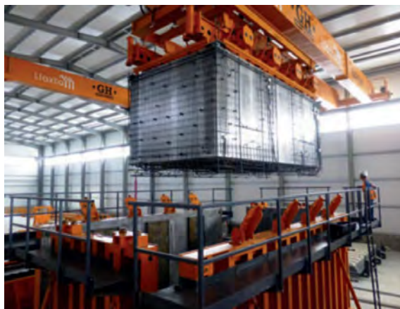
Figura 8. Núcleo se coloca en el encofrado del módulo.
