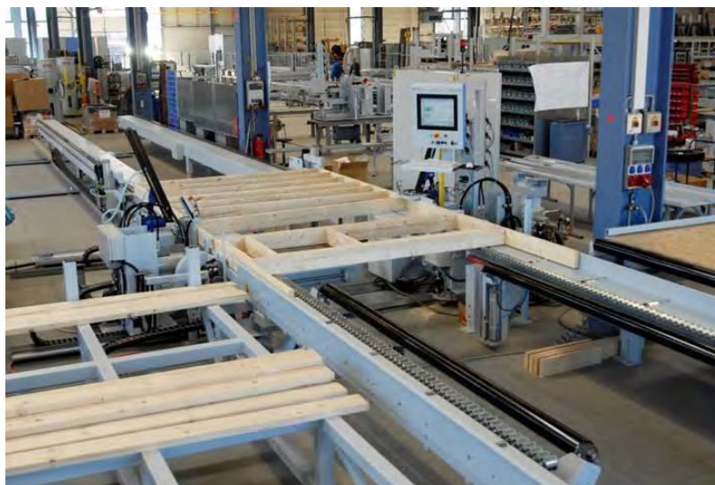
Figura 19. Máquinas CNC funcionando con Revit Tomado de “Running CNC Machines from Revit”, por Agacad (Lituania), 2021.
