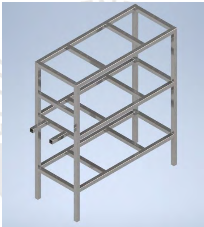
Figura 3.23: Estructura principal. Fuente: Elaboración propia.
