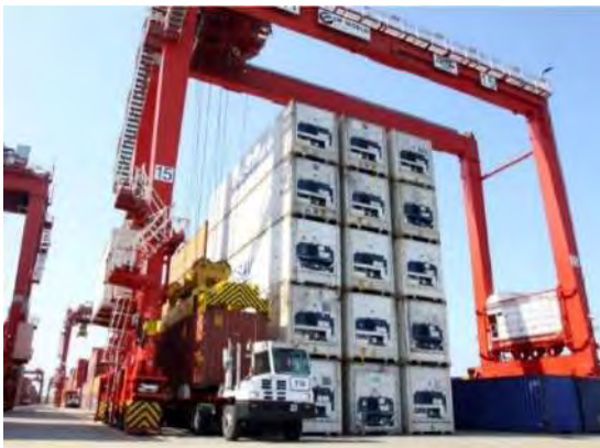
Fig. 1.10 Cables de acero a flexión en una grúa tipo RTG de 41t, puerto del Callao [10]
