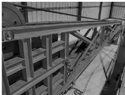
Fig. 2.8 Máquina de ensayos de flexión de cables de acero, MRE Rope Israel [9].
