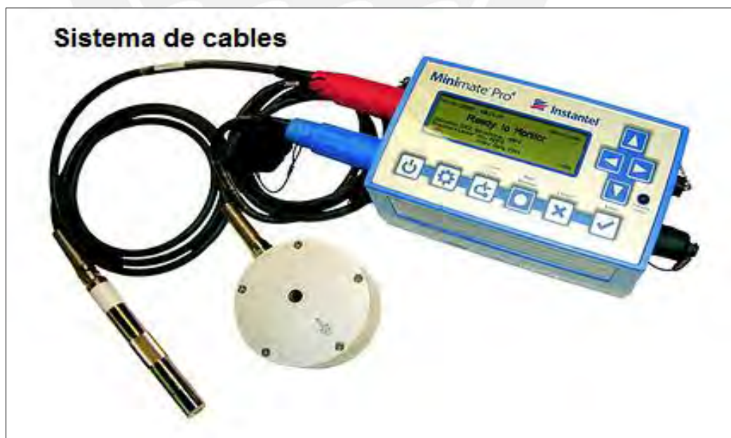
Figura 27. Sistema de Cables, equipo de monitoreo Instantel. Elaboración propia.
