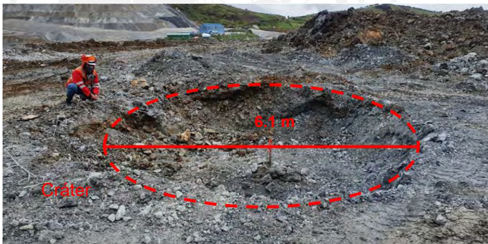
Figura 51. Posterior a la voladura en la prueba de crater – Cerro Corona Elaboración propia.
