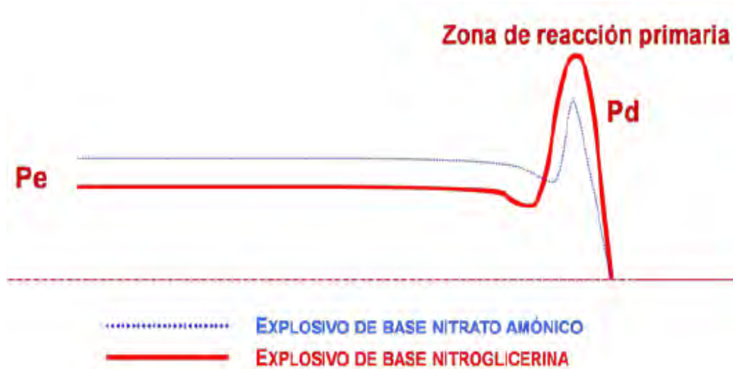
Figura 4. Presión de detonación (Pd) y presión de burbuja (Pe) de dos tipos de explosivo Tomado de Bernaola, Castilla & Herrera (2013): Perforación y voladura de rocas en minería
