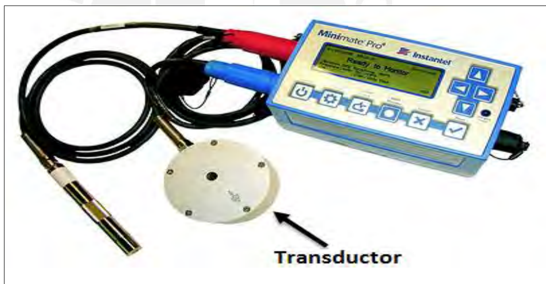
Figura 25. Transductor, equipo de monitoreo de vibraciones. Elaboración propia.
