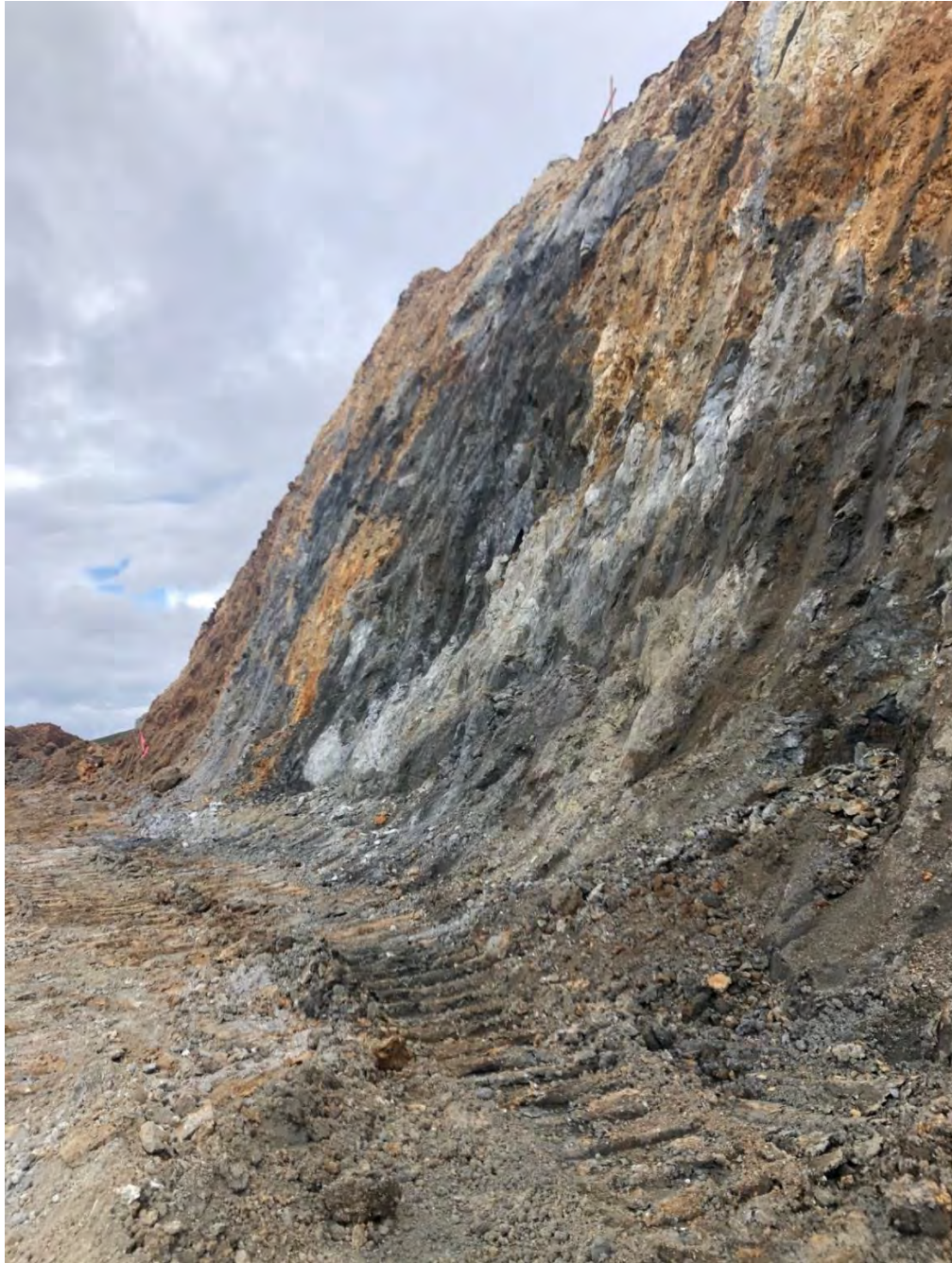
Figura 45. Perfil de taludes en el cerro María después del corte libre Tomado de “Mineral resources and mineral reserves supplement to the integrated annual report”, por GoldFields, 2020.
