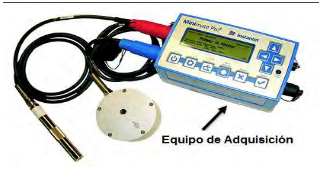
Figura 28. Equipo de Adquisición Instantel. Elaboración propia.
