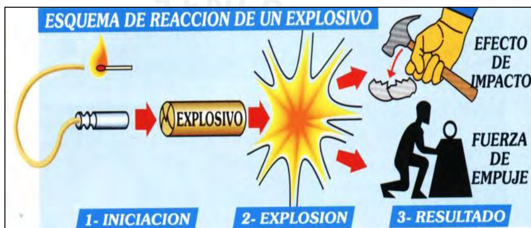
Figura 1. Esquema de reacción de un explosivo Tomado de Exsa (2013): Manual práctico de voladura
