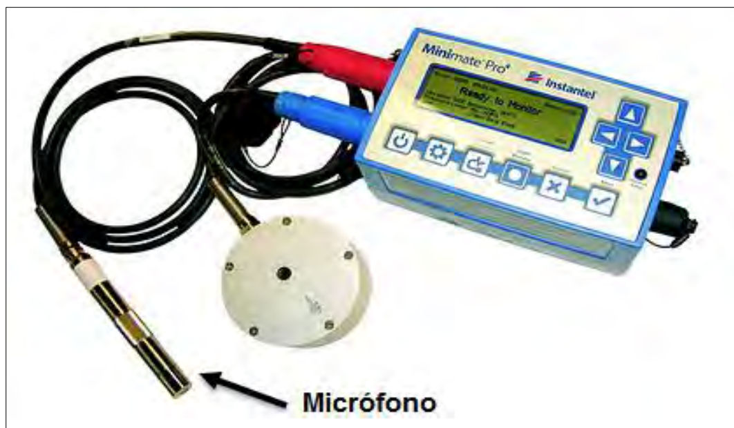
Figura 26. Micrófono, equipo de monitoreo Instantel. Elaboración propia.
