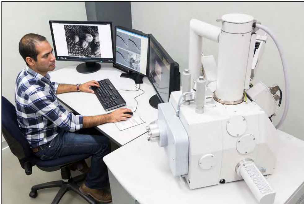
Figura 1.14. Observación de la superficie de fractura mediante SEM
