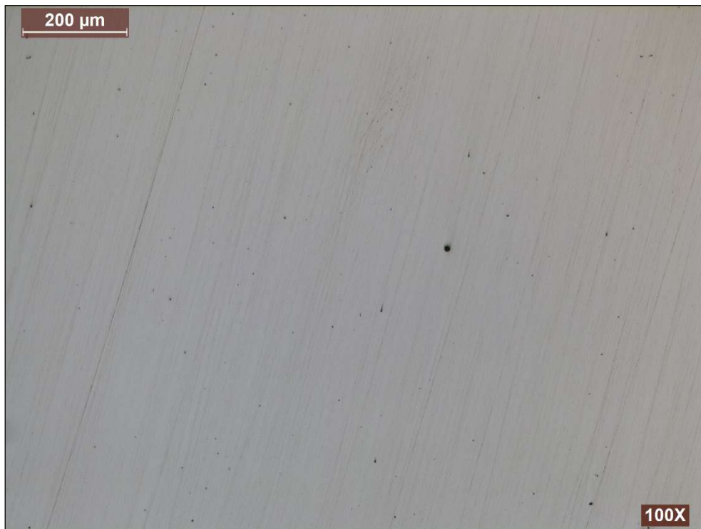
Figura 3.7. Metalografía de la probeta longitudinal sin ataque químico a 100x aumentos
