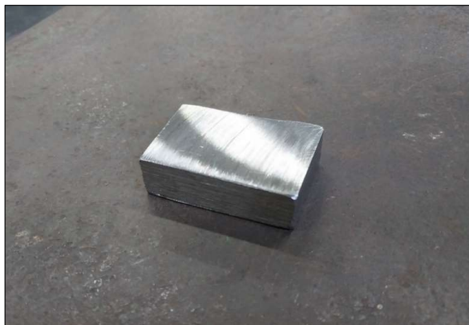
Figura 2.2. Muestra preparada para análisis químico
