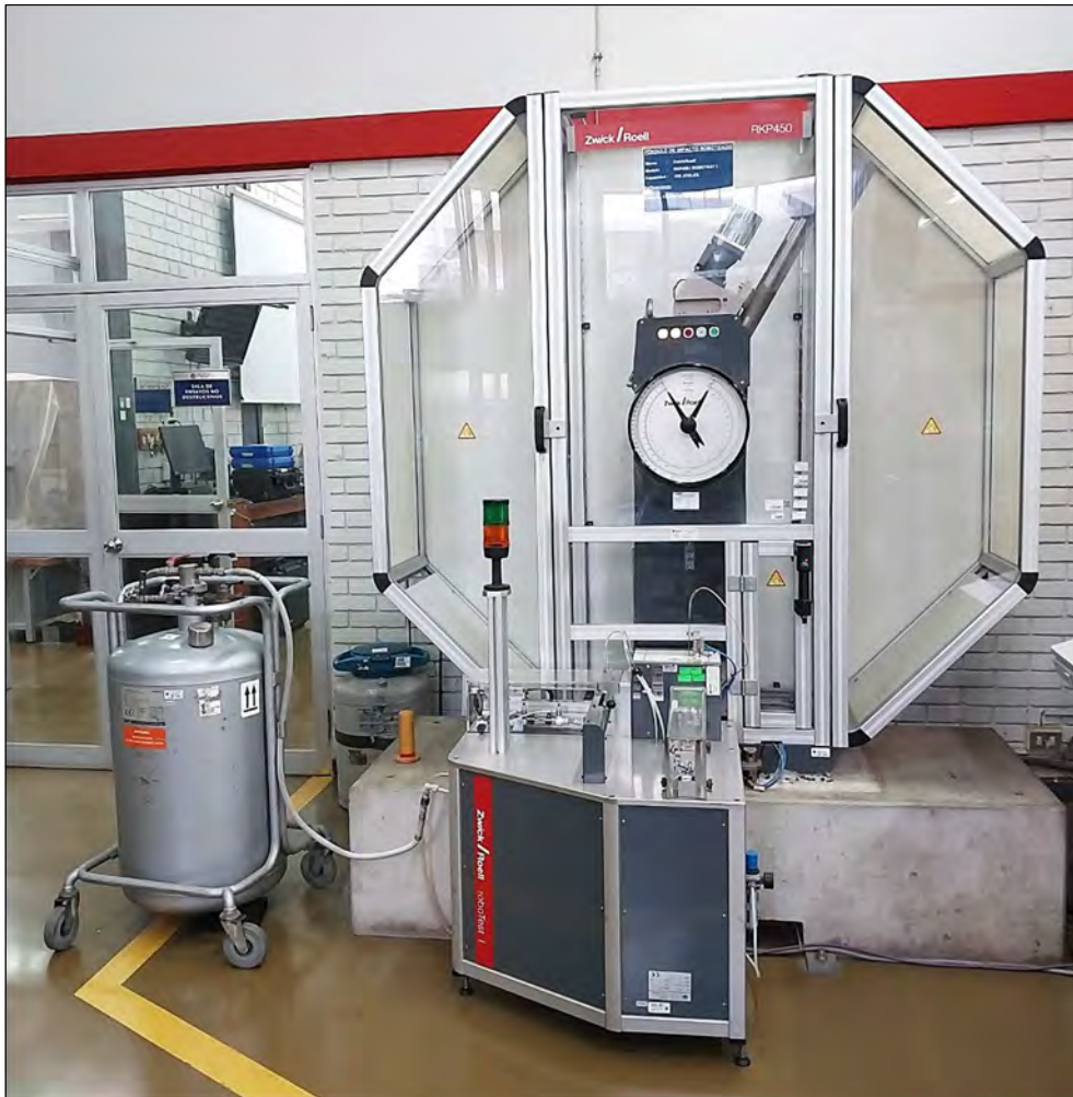
Figura 1.32. Péndulo para ensayo de impacto instrumentado marca ZwickRoell
