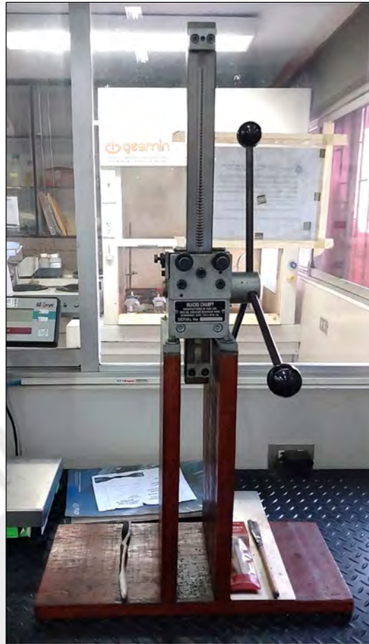
Figura 2.17. Brochadora charpy empleada
