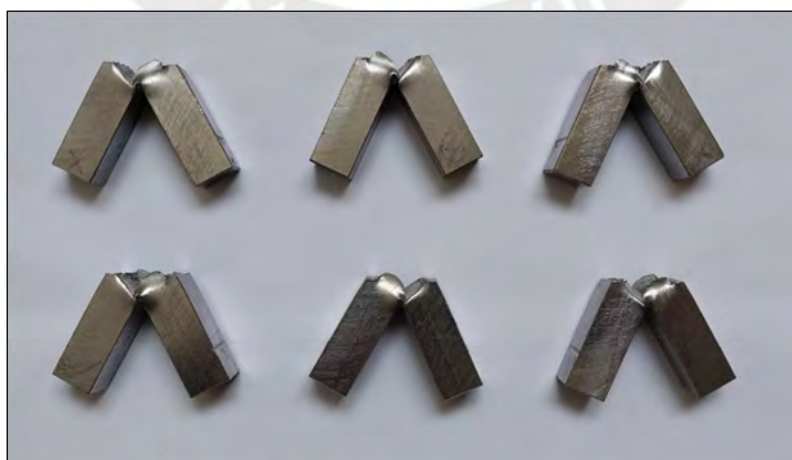
Figura 3.13. Probetas después del ensayo de impacto Charpy "V" Notch
