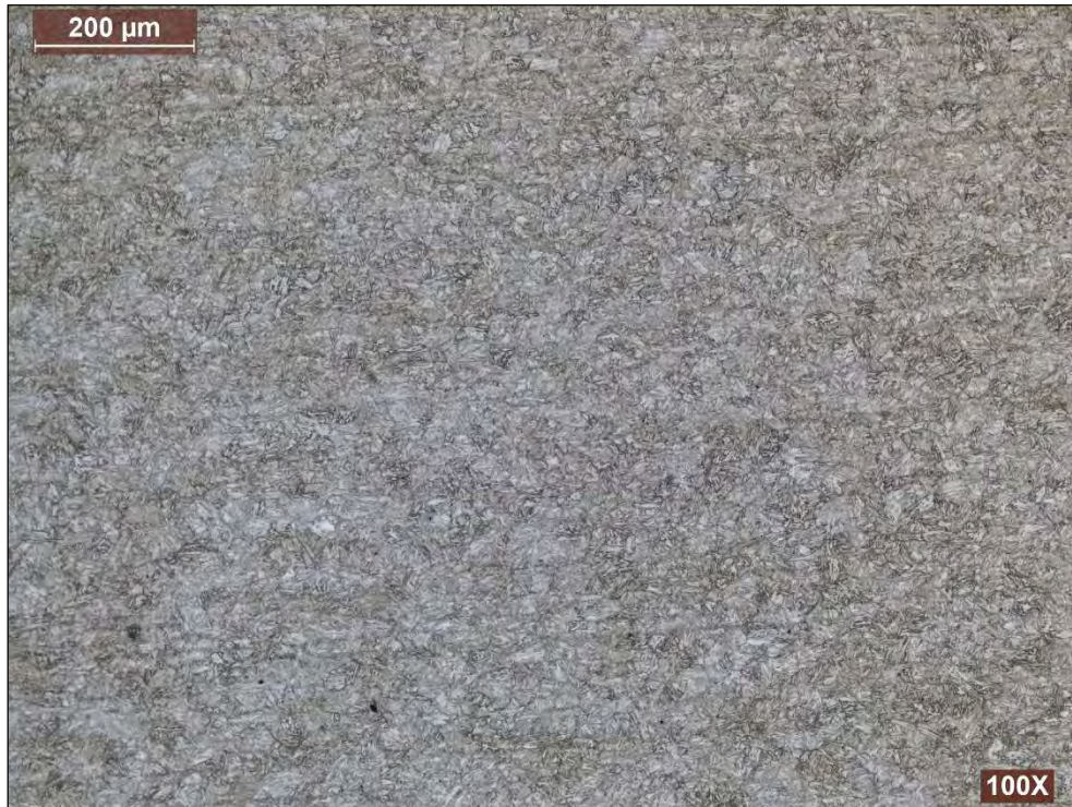
Figura 3.11. Metalografía de la probeta transversal con ataque químico a 100x aumentos
