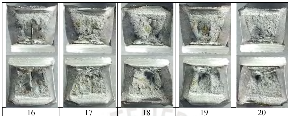
Figura 3.23. Superficies de fractura de las probetas ensayadas a -40^{\circ}\text{C}
