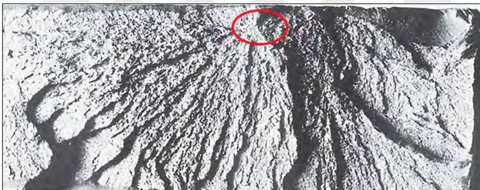
Figura 1.17. Fotografía de una superficie de fractura frágil que muestra radial en forma de abanico. Tomado de “ Fundamentals of Materials Science and Engineering - An Integrated Approach ”, por William D. Callister, David G. Rethwisch, 2015.
