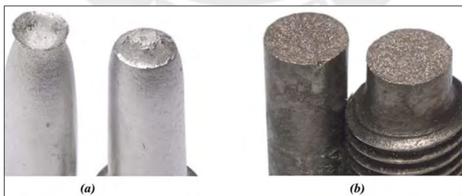
Figura 1.13. (a) Fractura de copa y cono en aluminio. (b) Fractura frágil en una fundición gris
