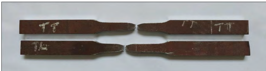
Figura 3.2. Probetas fracturadas del ensayo de tracción
