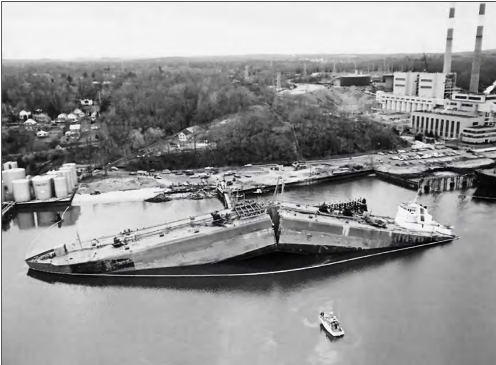
Figura 1.22. El buque Liberty S.S. Schenectady falló antes de abandonar el astillero (1943)
