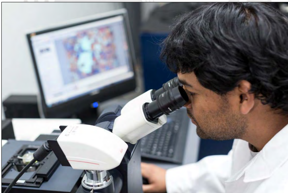
Figura 1.28. Observación de la microestructura mediante un microscopio óptico
