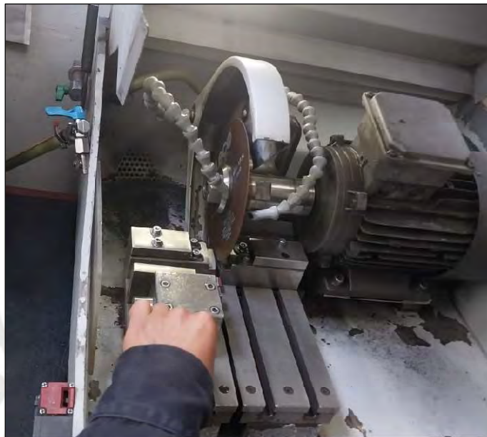
Figura 2.12. Corte para la extracción de la muestra
