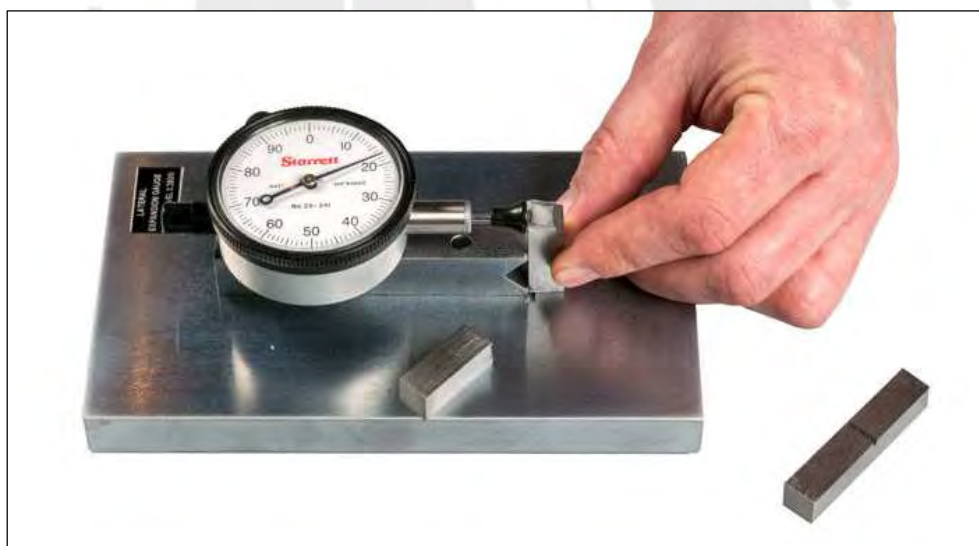
Figura 1.31. Medidor de expansión lateral para probetas de impacto
