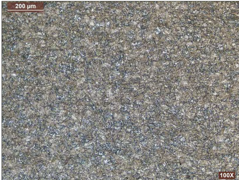
Figura 3.9. Metalografía de la probeta longitudinal con ataque químico a 100x aumentos
