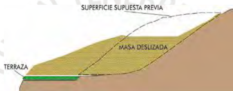
Figura 3.1 Partes de un deslizamiento
