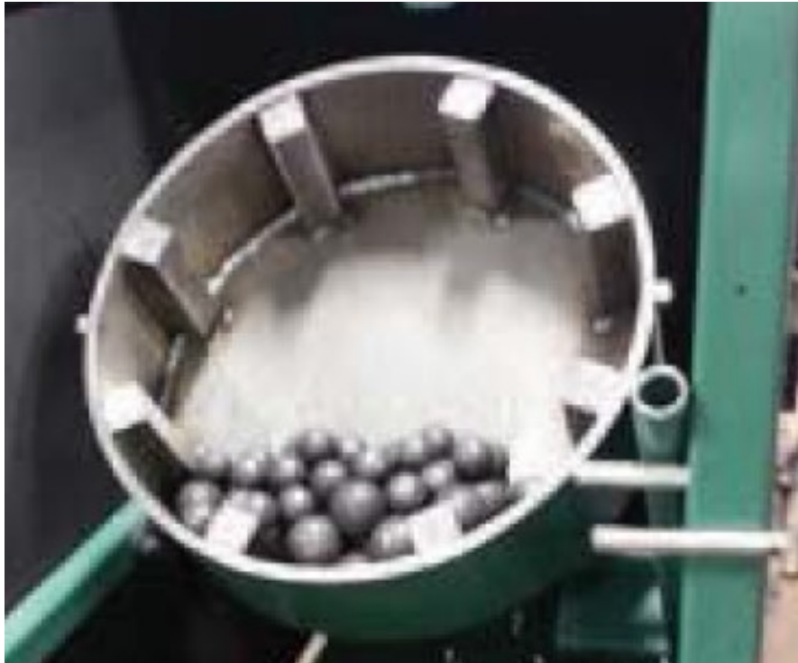
Figura 1.8: Medios de molienda utilizado para molinos SAG Tomado de “Comminution Handbook” por Lynch (2015)
